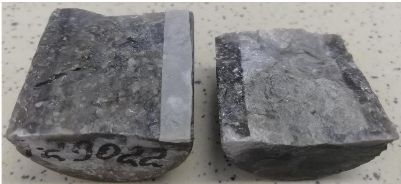
Рисунок 41 - Поверхность трещины после опыта №1: слева – с частицами полимера, справа – вторая половина образца, отмытая от частиц полимера.
