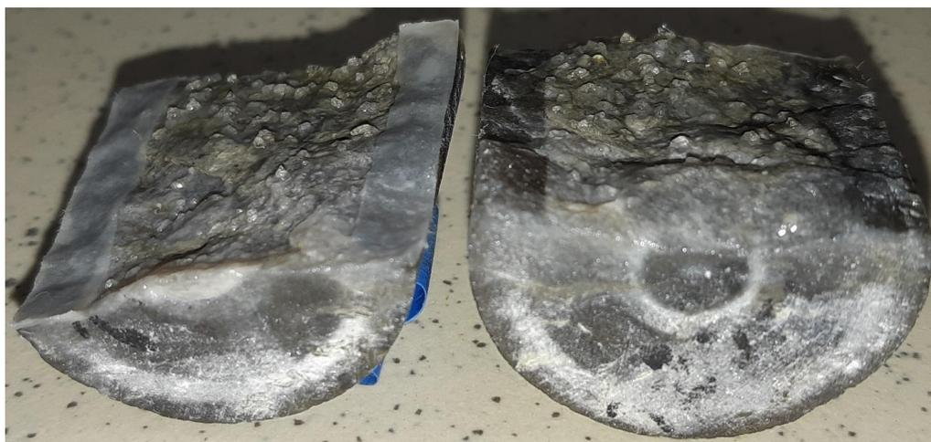
Рисунок 43. Фотография поверхности трещины после опыта №2
