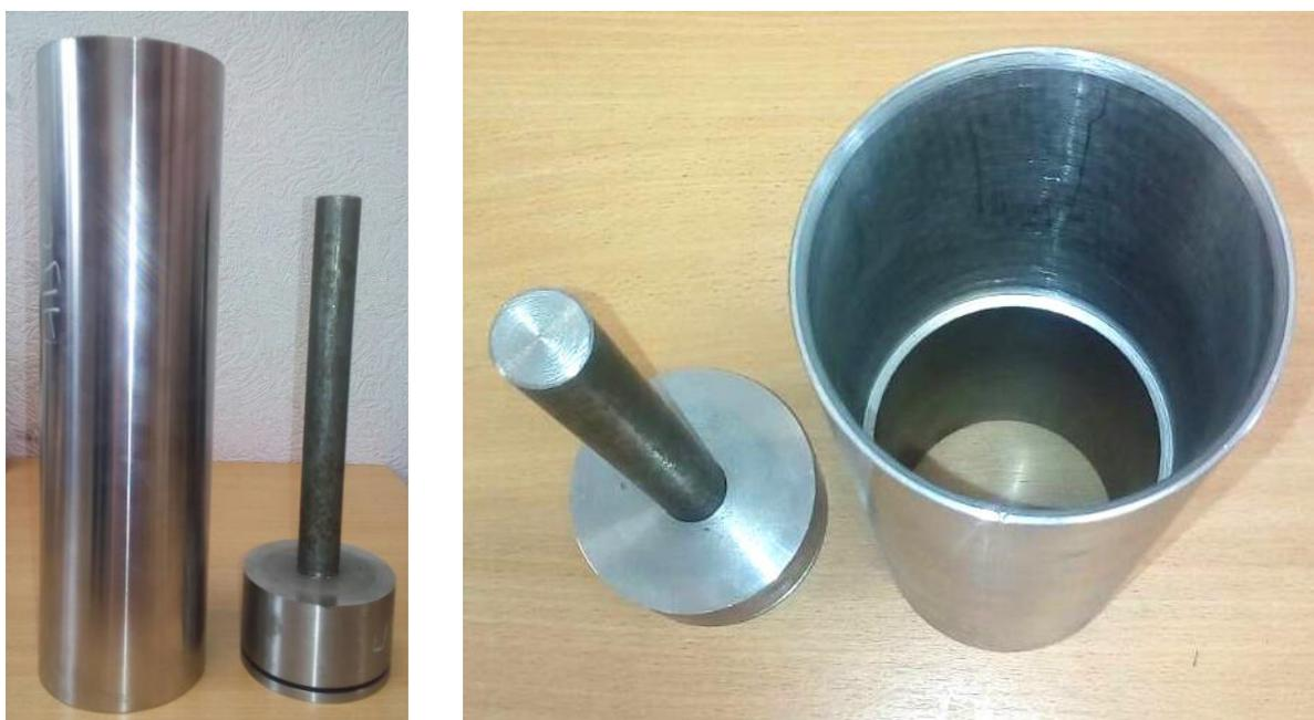
Рисунок 29 - Поршень и цилиндр для проведения испытаний на прочностной машине.
