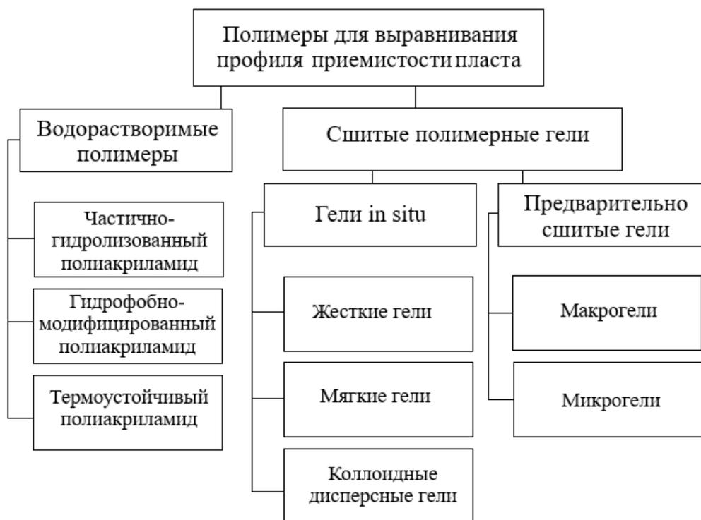
Рисунок 1 - Классификация составов полиакриламида для воздействия на профиль приемистости пласта
