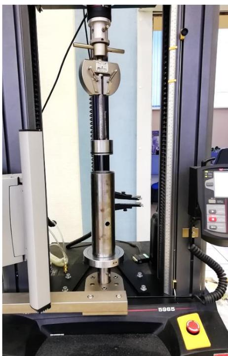
Рисунок 30 - Прочностная машина с цилиндром и поршнем.
