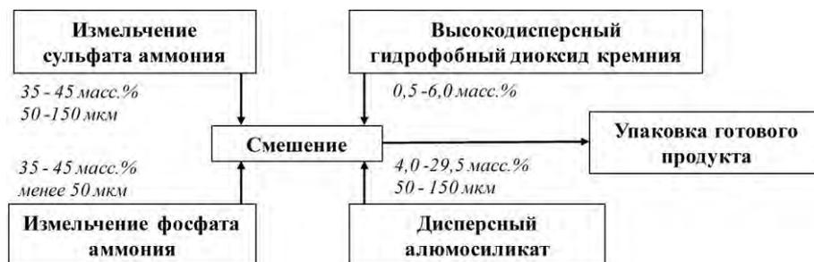
Рисунок 5.1 – Функциональная схема получения огнетушащего порошка с отдельным измельчением компонентов
