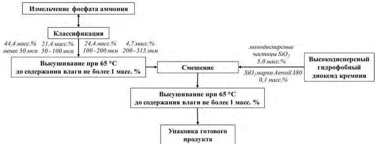
Рисунок 5.4 – Функциональная схема получения огнетушащего порошкового состава с супергидрофобным функциональным наполнителем
