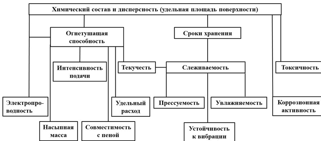
Рисунок 1.1 – Взаимозависимость основных характеристик ОПС
