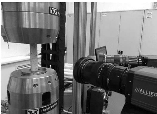
Рис. 8 – Фотография испытательной системы Instron 8852 и видеосистемы Vic 3D для испытаний на растяжение с кручением трубчатых образцов
