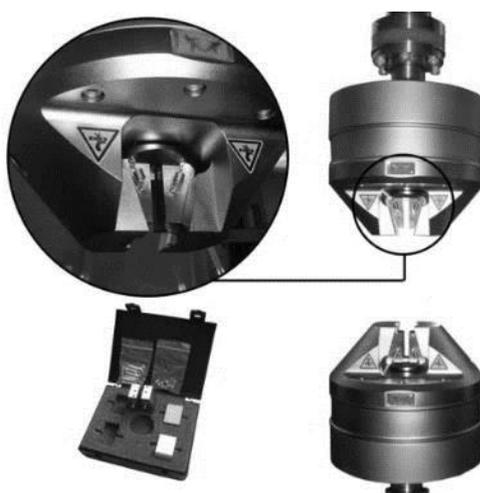
Рисунок 2.5 – Пневматические захваты клинового типа.
