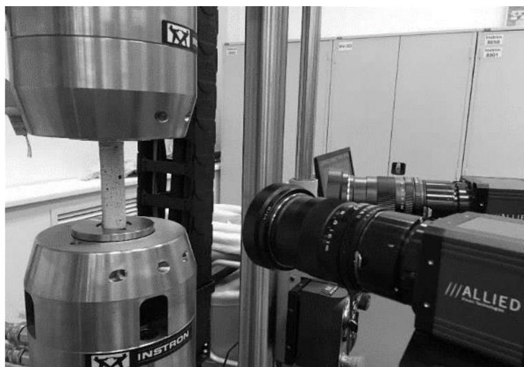
Рисунок 3.20 – Фотография испытательной системы Instron 8852 и видеосистемы Vic 3D при испытаниях на растяжение с кручением трубчатых образцов
