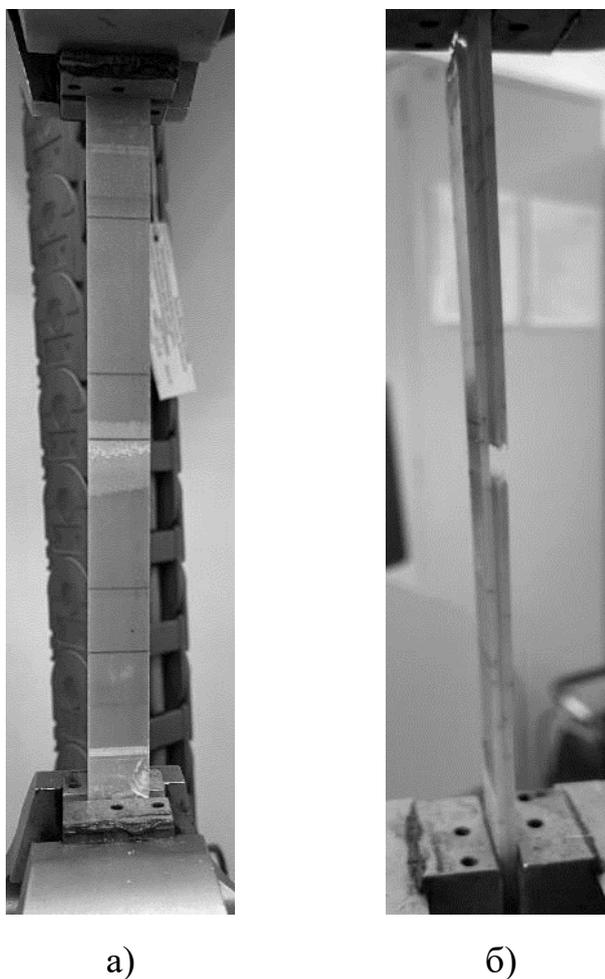
Рисунок 4.9 – Фотографии разрушенных стеклопластиковых образцов (а – нормальный отрыв, б – расслоения)
