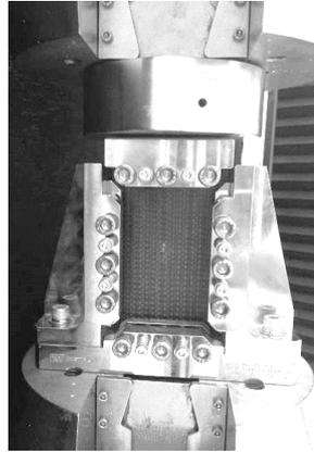
Рисунок 4.33 – Фотография зажимного приспособления для испытания на сжатие с установленным образцом
