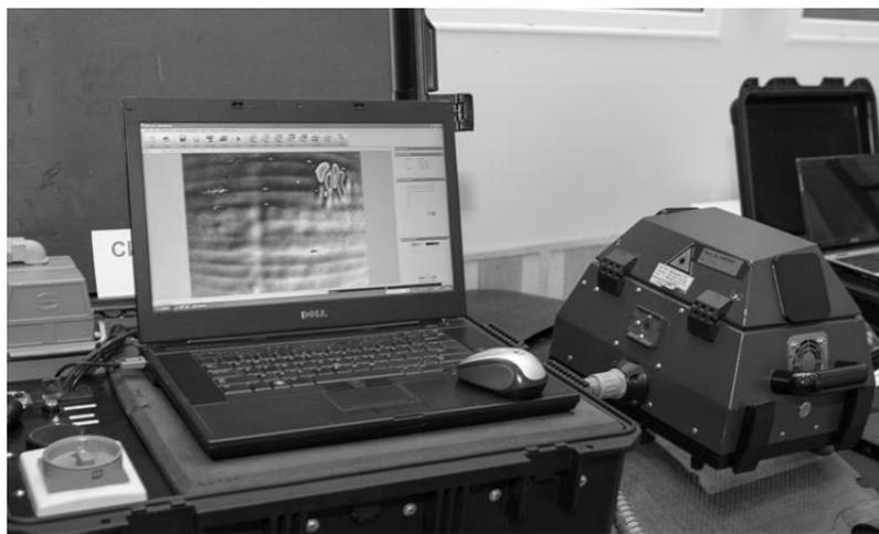
Рисунок 4.30 – Фотография системы шерографии Steinbichler ISIS mobile 3100 при проведении исследования
