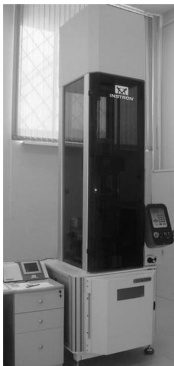
Рисунок 2.8 – Фотография измерительного стенда-копра Instron CEAST 9350
