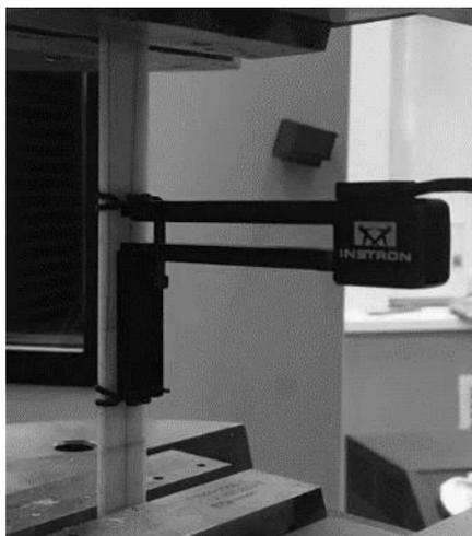
Рисунок 2.2 – Фотография навесного датчика деформаций в процессе квазистатического растяжения стеклопластикового образца
