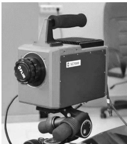
Рисунок 2.14 – Фотография инфракрасной тепловизионной системы Flir SC7700M
