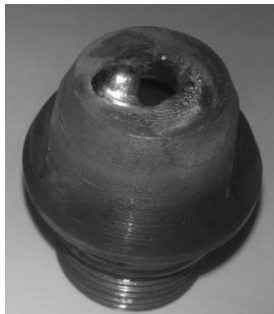
Рисунок 42. Локальное разрушение плазмообразующего канала кольцевого анода
