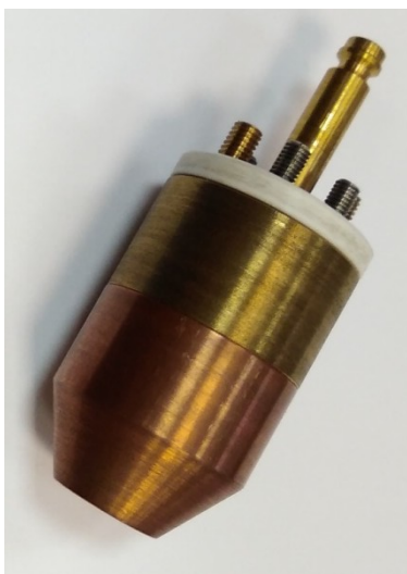
Рисунок 47. Плазмотрон для процесса плазма-МИГ без стабилизирующего сопла: 1 - в сборе; 2 – в разобранном виде
