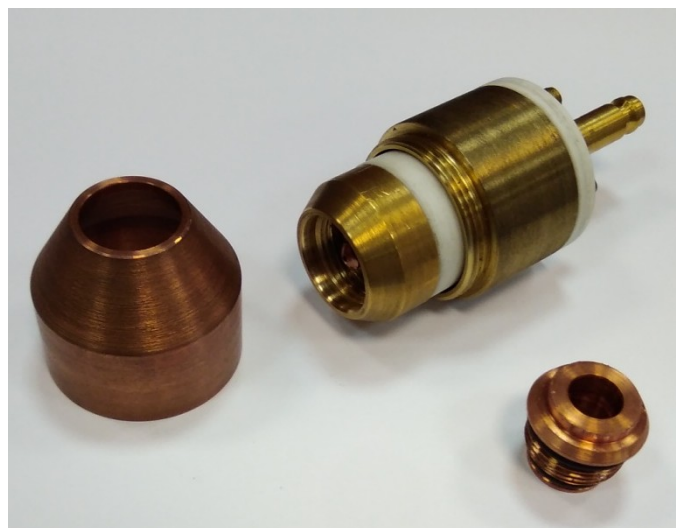
Рисунок 47. Плазмотрон для процесса плазма-МИГ без стабилизирующего сопла: 1 - в сборе; 2 – в разобранном виде
