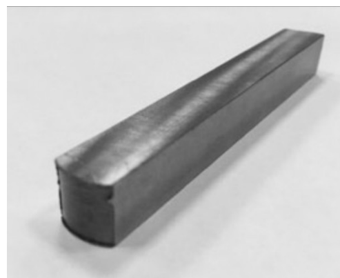
Рисунок 70. Схема вырезки образцов для проведения исследования механических характеристик материала: а – схема вырезки образцов (1 – поперек слоев, 2 – вдоль слоев), б – фото образца
