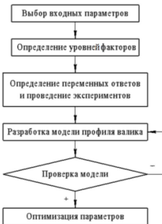
Рисунок 36. Схема вычисления профиля валика методом аппроксимации [144]
