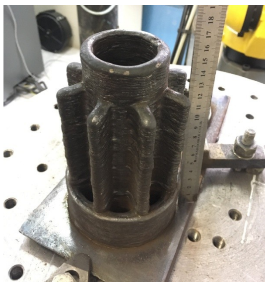
Рисунок 56. Заготовки деталей (сердечник - слева, импеллер - справа), созданные на роботизированном комплексе
