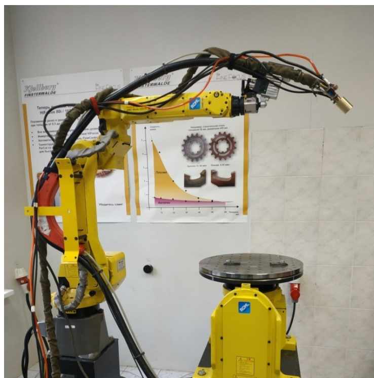
Рисунок 55. Компонировка оборудования для WAAM на базе роботизированного комплекса
