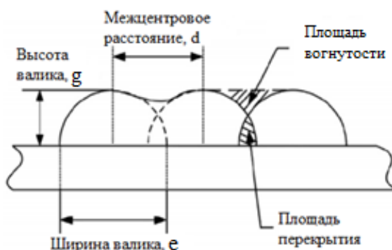
Рисунок 4. Схема наплавленного слоя [20]
