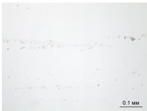
Рисунок 77. Дефекты металла образца №1 (подложка из стали 04X19H9): а – до травления, б – после травления
