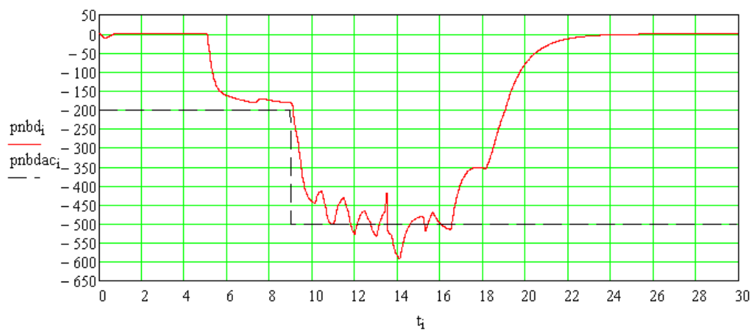
Рис. Г10. Программное и текущее значение ускорения частоты вращения ротора КВД
