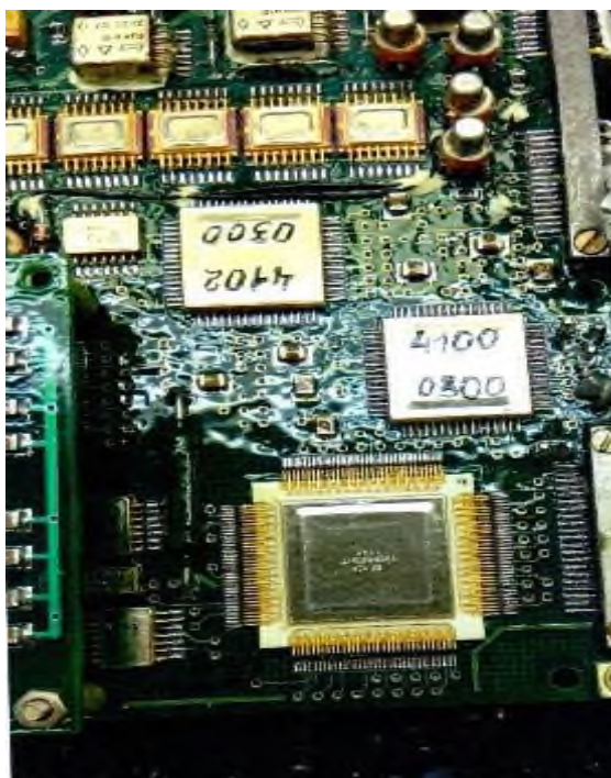
Рис. 4.7 Аппаратная реализация адаптивного нечеткого регулятора
