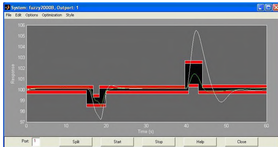
Рис. 2.9. Осциллограммы процесса оптимизации нечеткого регулятора в NCD-Blockset в системе регулирования
