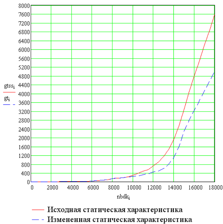
Рис. 2.20. Статические характеристики двигателя по расходу топлива
