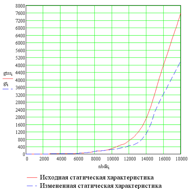
Рис. Д1. Статические характеристики двигателя по расходу топлива
