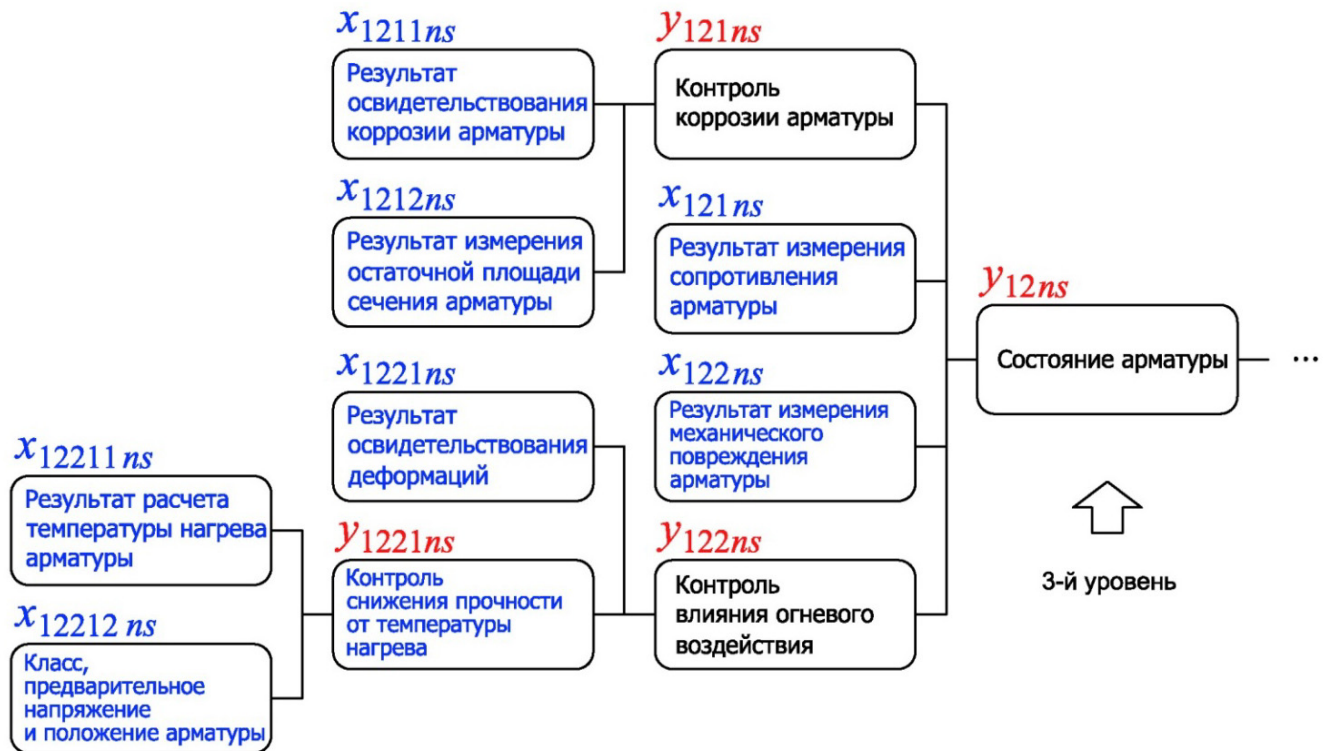
Рисунок 2.9 – Фрагмент онтографа онтологии «Состояние арматуры», как части содержимого онтологии «Состояние нормальных сечений»
