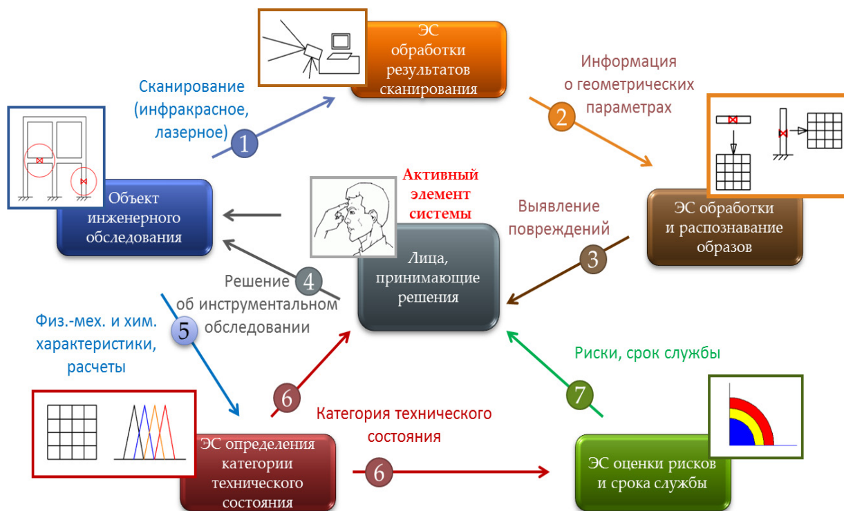
Рисунок 1.6 – Структура комплексной интеллектуальной системы обследования конструкций объектов массового строительства
