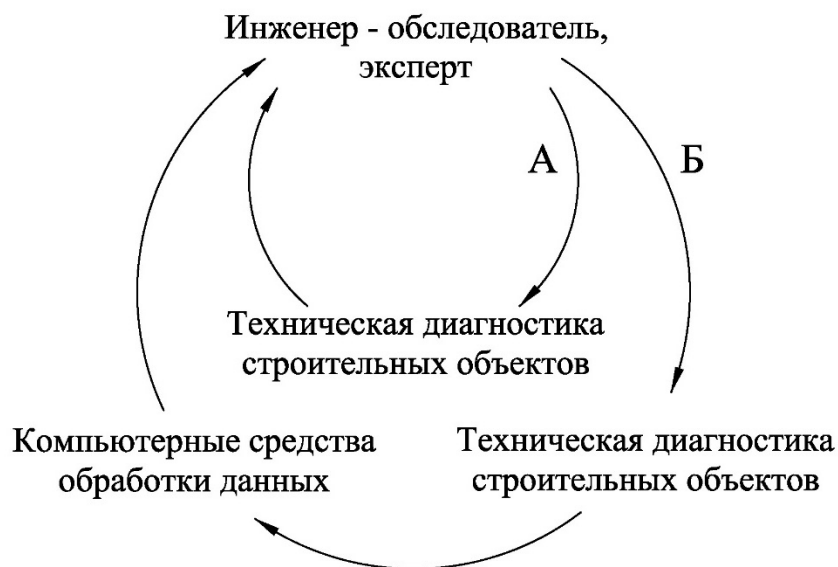
Рисунок 1.2 – Связь ресурсов в технологии решения задач диагностики эксплуатируемых строительных объектов: А – существующий технологический уровень; Б – концептуальный технологический уровень
