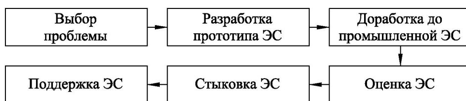
Рисунок 1.4 – Этапы разработки экспертной системы (ЭС)
