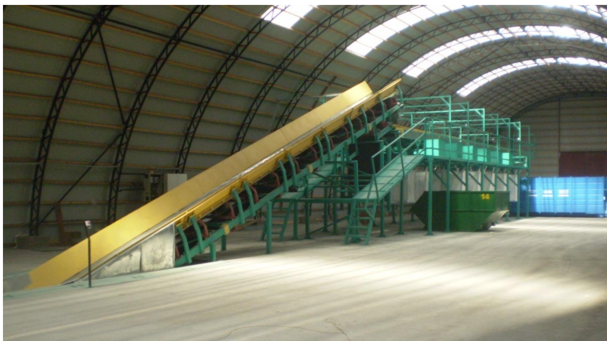
Рисунок 1.4 – Пример промышленной линии сортировки ТКО, распознающий отходы с оптического датчика по прозрачности материала
