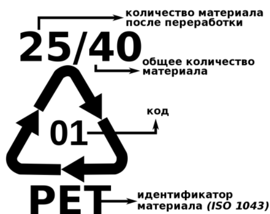
Рисунок 1.2 – Код переработки утверждённый Европейской комиссией 97/129/ЕС, обозначающий применение в изделии полиэтилентерефталата
