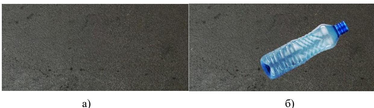
Рисунок 2.7 – Пример изображений с камер, установленных над конвейером (а – пустой конвейер, б – ПЭТ бутылка на конвейере)
