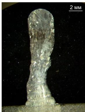
Рисунок 3. Поперечный шлиф образца, полученного в результате электронно-лучевой наплавки проволокой
