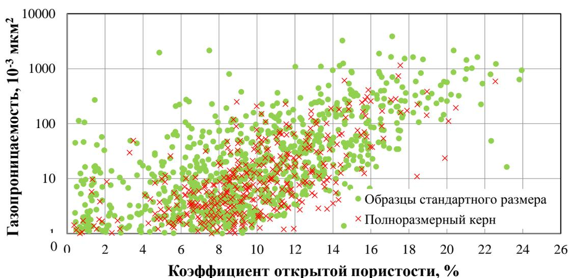
Рис. 3. Зависимость газопроницаемости от пористости
