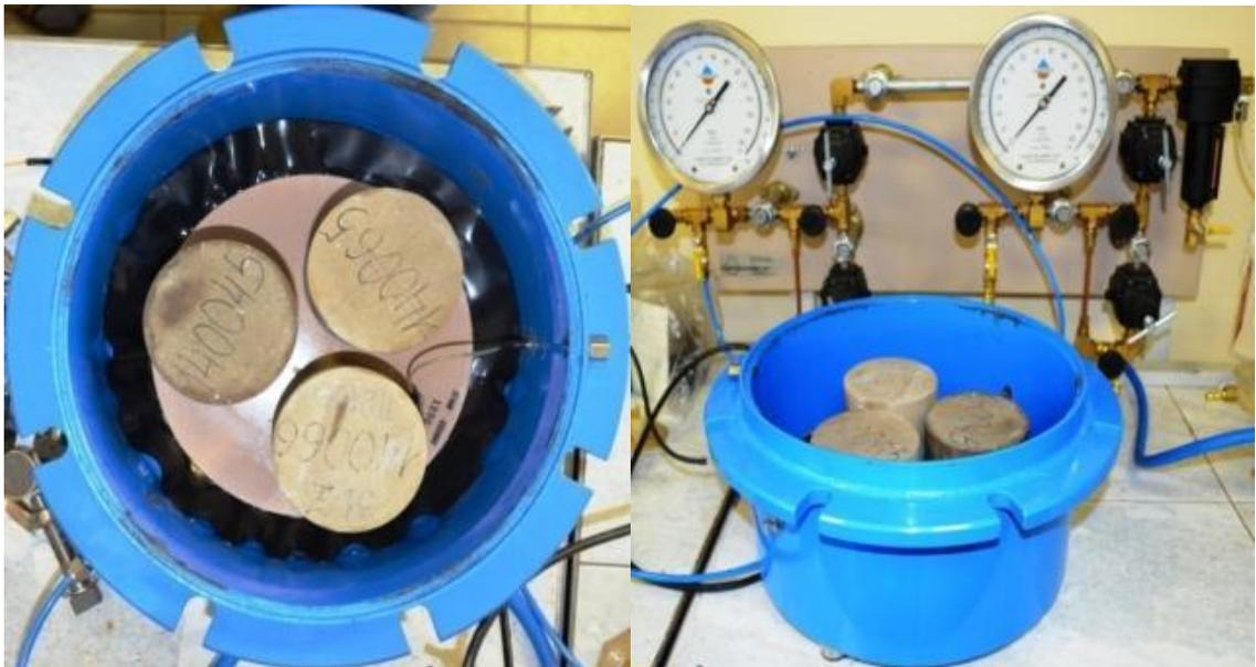
Рис. 2.11. Групповая капилляриметрическая установка
