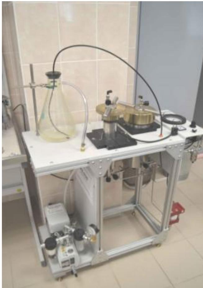
Рис. 2.1. Ручной сатуратор
