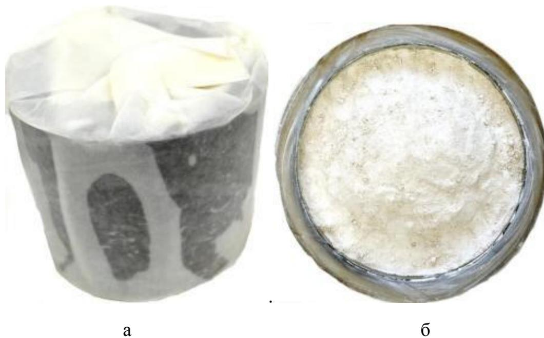
Рис. 2.8. (а) образец, обернутый в фильтровальную бумагу, пропитанную солевым раствором; (б) образец в эксикаторе с мелкодисперсной средой
