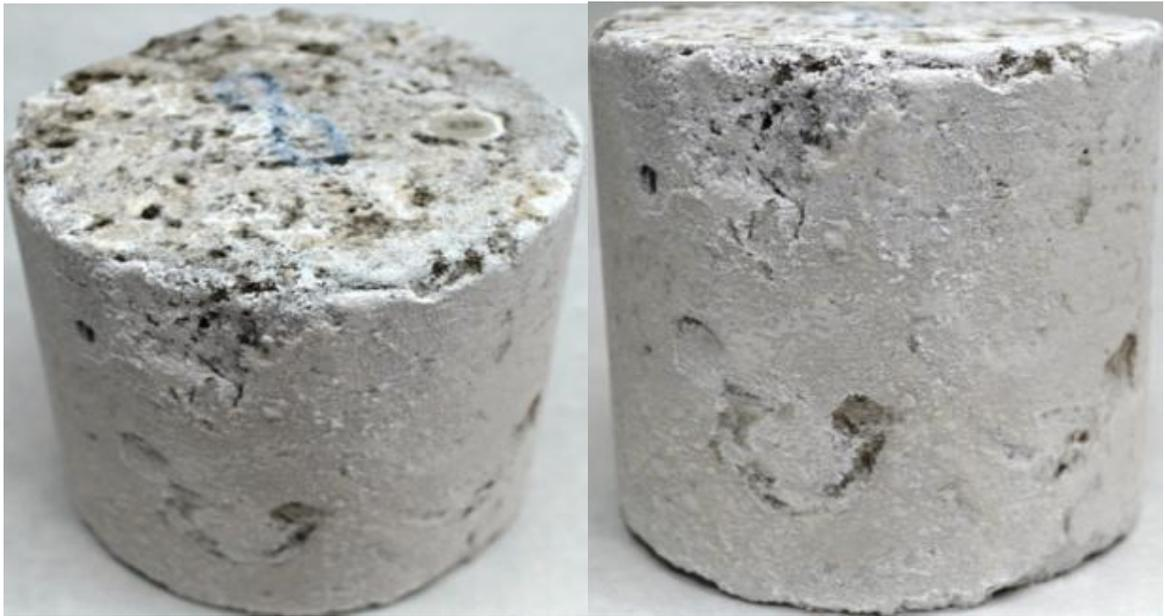
Рис. 2.12. Внешний вид образцов при моделировании остаточной водонасыщенности методом высушивания
