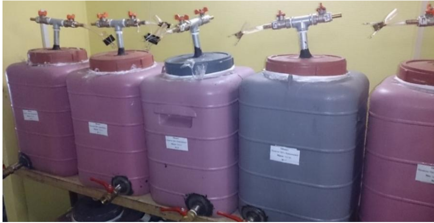
Рисунок 2.4 – Лабораторный комплекс по моделированию процессов разложения отходов
