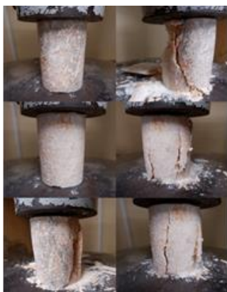
Рис. 1. Лабораторное оборудование для проведения испытаний на одноосное сжатие (электромеханический пресс Zwick/Z250 ( a )); Примеры испытания образцов ( б )
