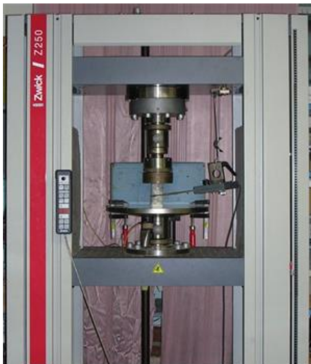
Рис. 1. Лабораторное оборудование для проведения испытаний на одноосное сжатие (электромеханический пресс Zwick-250)
