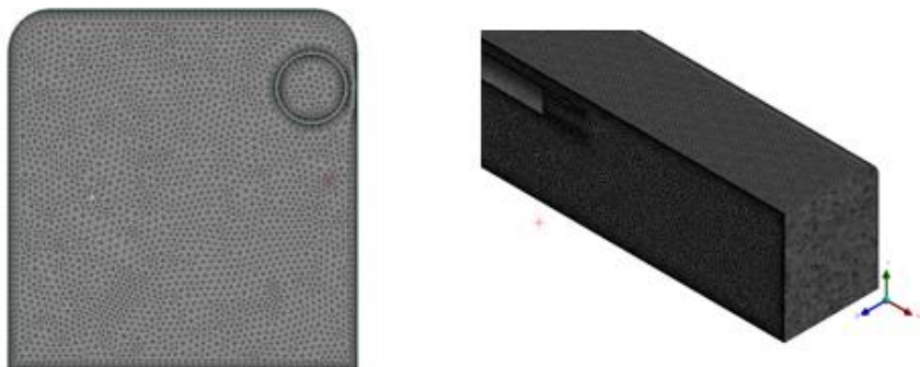
Рис.1. Фронтальная и аксонометрическая проекции расчетной области, разбитой на сетку
