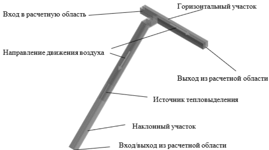
Рис. 1. Геометрическая модель участка вентиляционной сети с наклонным элементом
