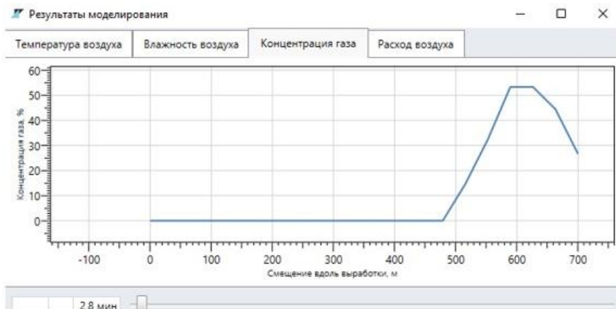
Рис. 3. Результаты моделирования при скорости воздуха 1,6 м/с
