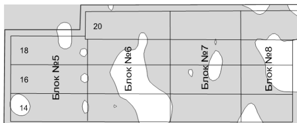
Рис.1. Прогнозная карта зон, опасных по ГДЯ из кровли пласта КрII, на шахтном поле рудника БКПРУ-2 по новым данным
