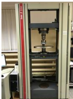
Рис. 1. Лабораторное оборудование для проведения испытаний на одноосное сжатие (электромеханический пресс Zwick/Z250 ( a )); Примеры испытания образцов ( б )
