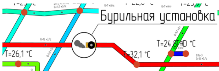
Рис. 6. Влияние бурильной установки на температуру воздуха в выработке
