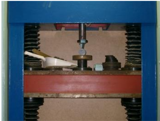
Рис. 2. Установка определения по растяжению (электромеханический пресс 1231-У10)
