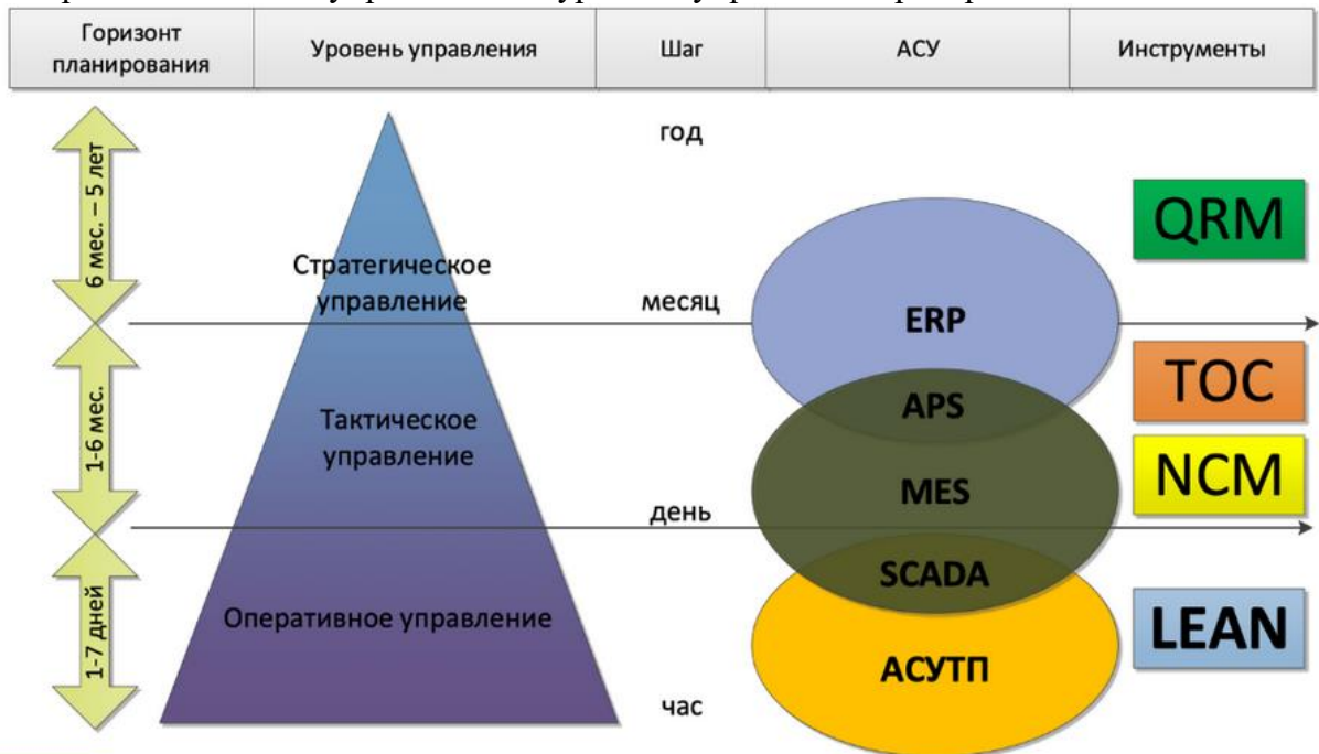
Рисунок 2 – Сводная диаграмма распределения инструментов и автоматизированных систем управления по уровням управления предприятием
