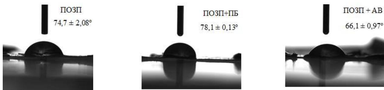
Рисунок 3 – Угол смачивания нативного и пламенномодифицированных образцов ПОЗП
