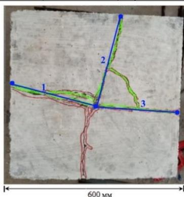
**Рисунок 7** - Характер разрушения образца ТБ11. Коэффициент извилистости на различных участках
