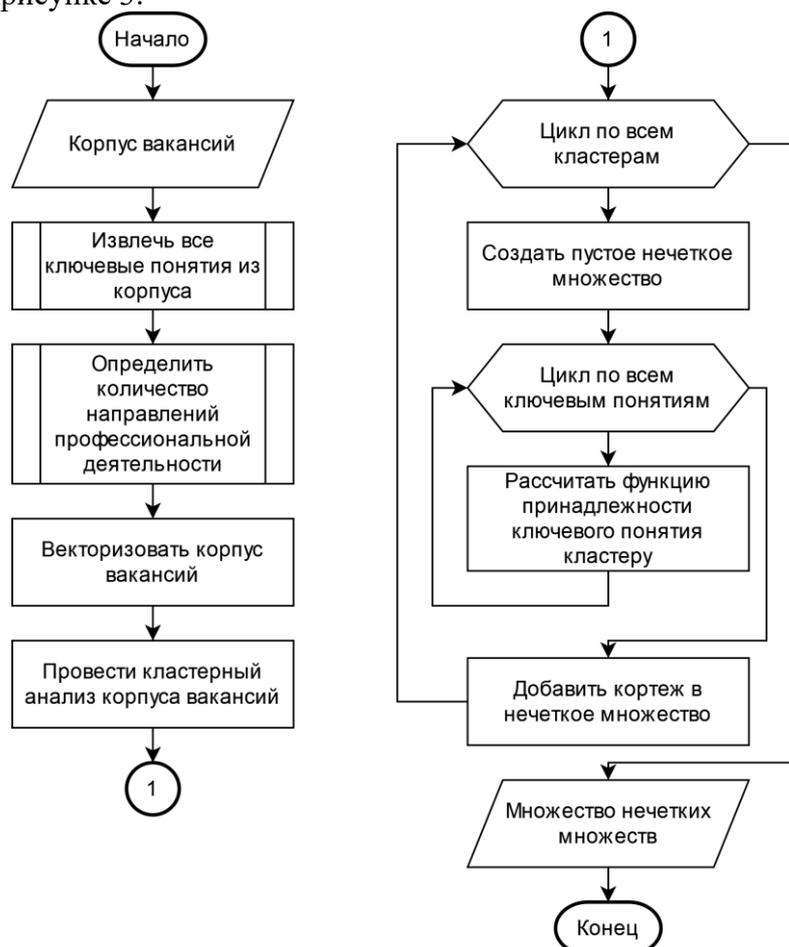
Рисунок 3 — Алгоритм автоматизированного моделирования специалиста-соискателя
