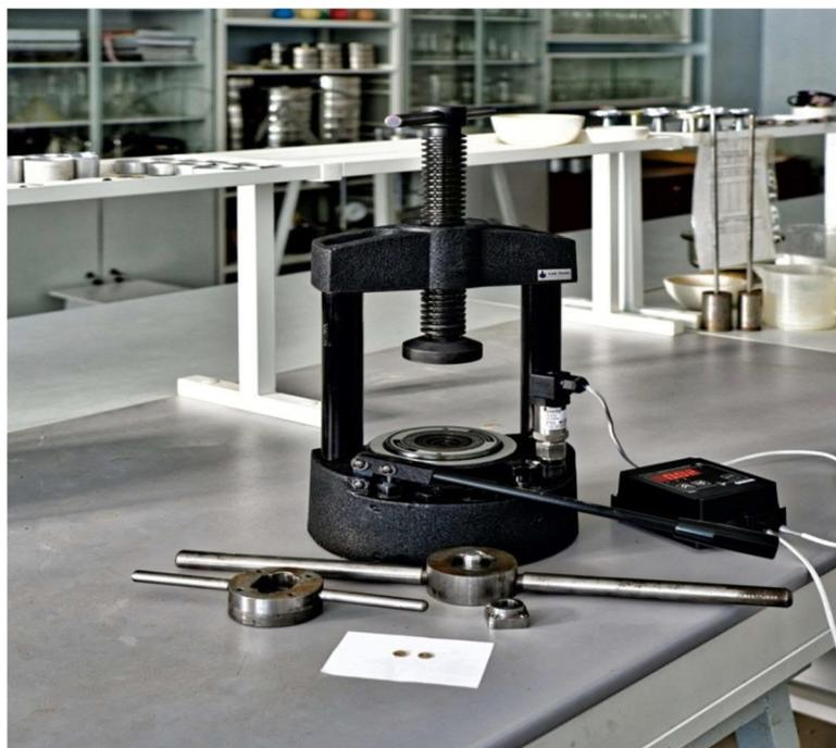
Рисунок 3 – Оборудование для изготовления образцов
