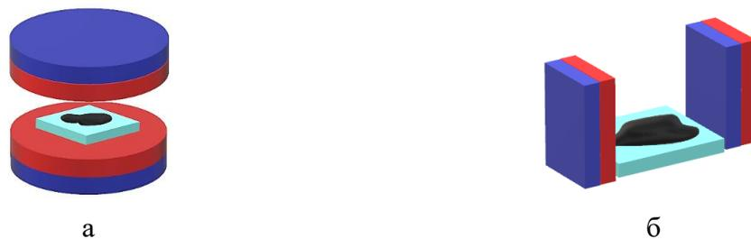
Рисунок 4.1 – Схемы расположения постоянных магнитов с различной конфигурацией относительно подложки с нанесенной суспензией
