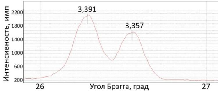
Рисунок 3.6 – Участок дифрактограммы суспензии (состав – С4) с отмеченными межплоскостными расстояниями ( $d_{002}$ ,  $\text{\AA}$ ) в диапазоне углов  $2\theta$  от  $26^\circ$  до  $27^\circ$
