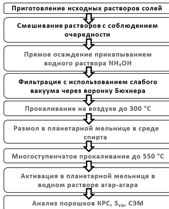
Рисунок 2.1 – Технологическая схема золь-гель синтеза порошков на основе диоксида циркония методом прямого соосаждения солей
