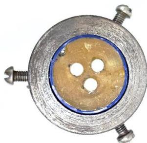
Рисунок 2.5 – Держатель с установленной заливкой с контртелами
