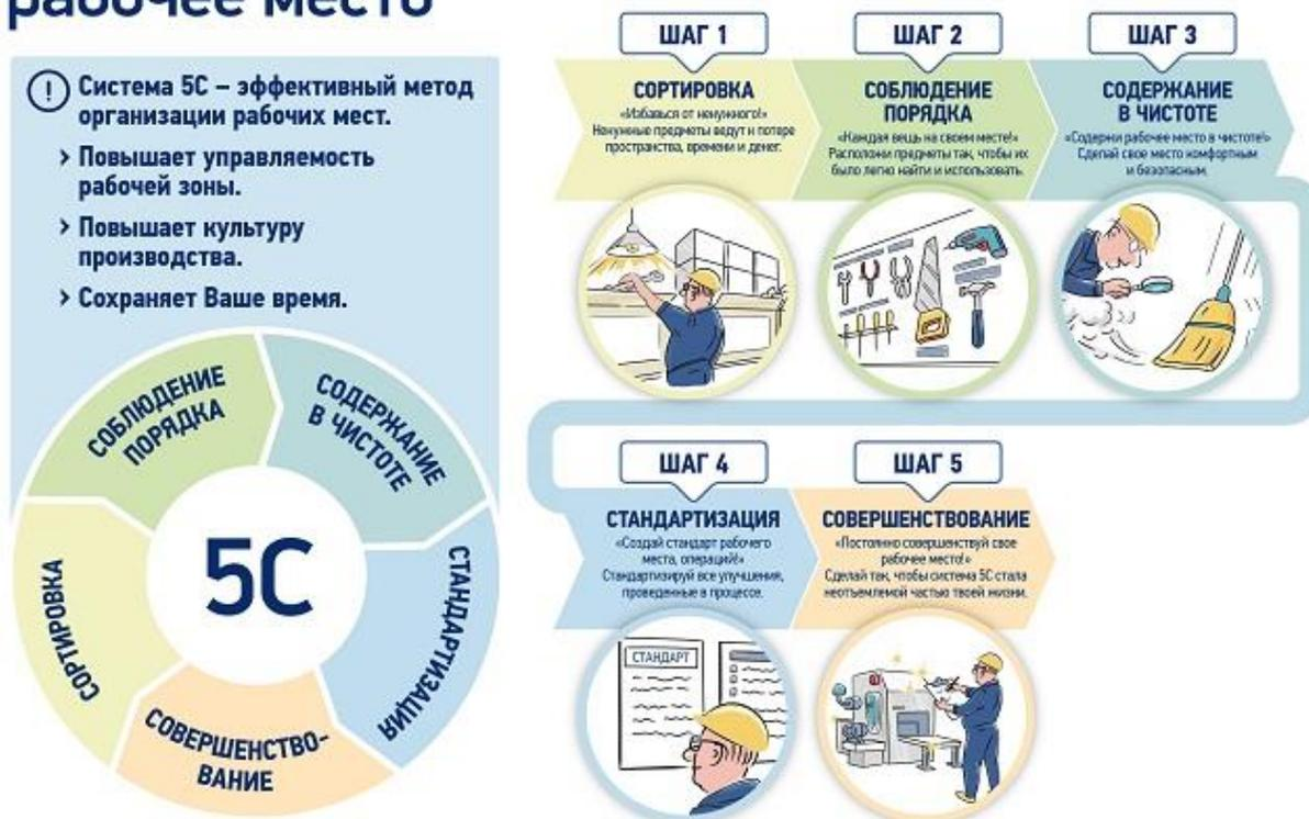
Рисунок 5 – Плакат с основными принципами системы 5S
