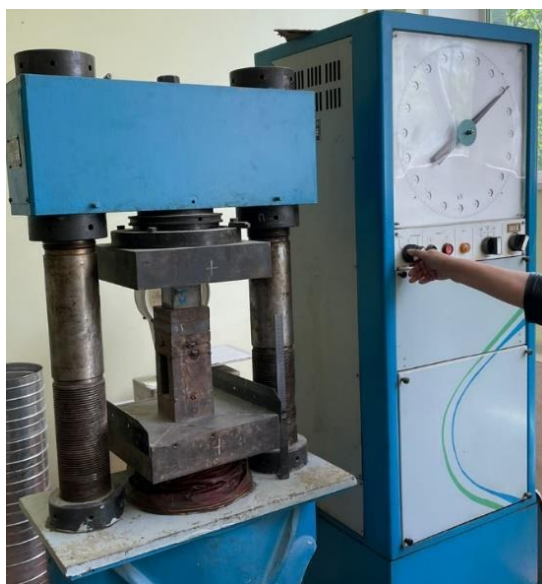
Рисунок 2.16 – Определение предела прочности образцов при сжатии
