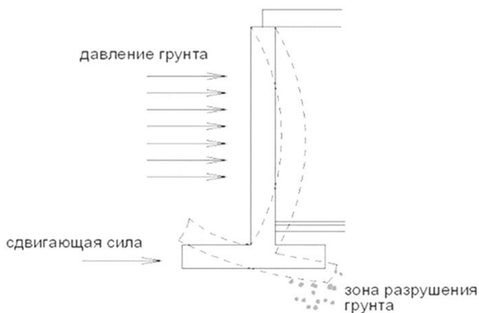
Рисунок 1.4 – Работа несущих элементов подземных объектов
