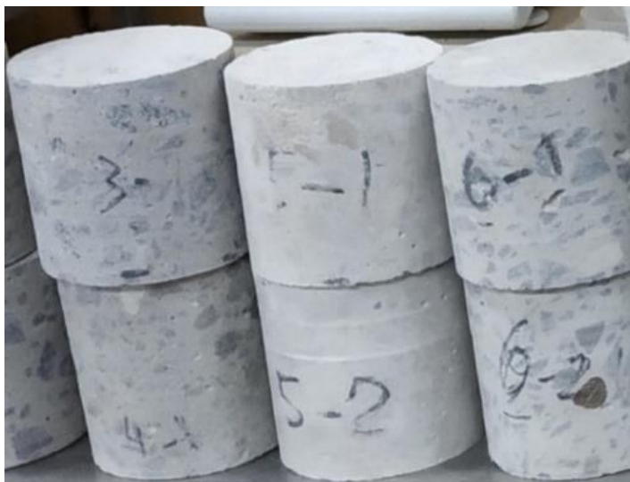
Рисунок 2.24 – Цилиндрические керны диаметром и высотой 100 мм, выбуренные алмазным буром
