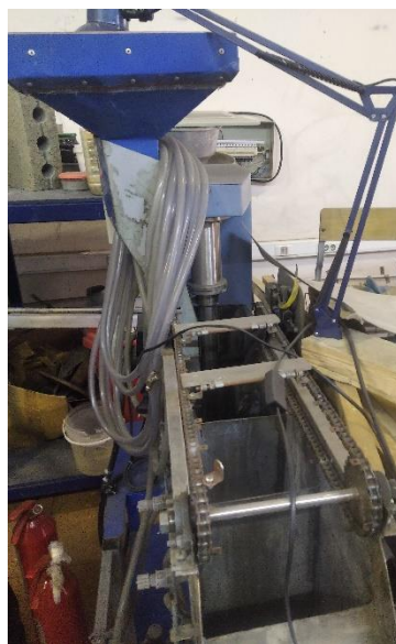
Рисунок 3.1 – Флотация золошлаковой смеси
