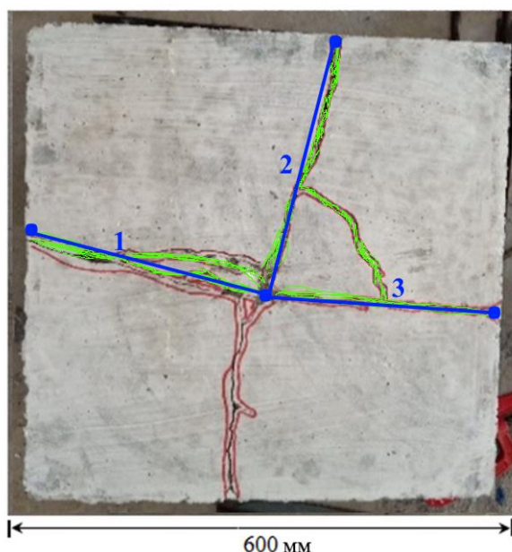
Рисунок 4.2– Характер разрушения образца ТБ11. Коэффициент извилистости на различных участках K_{cuv} = l_f / l_s : 1 - \frac{52 \text{ см}}{34 \text{ см}} = 1,53 ; 2 - \frac{58 \text{ см}}{35 \text{ см}} = 1,66 ; 3 - \frac{57 \text{ см}}{34 \text{ см}} = 1,68
