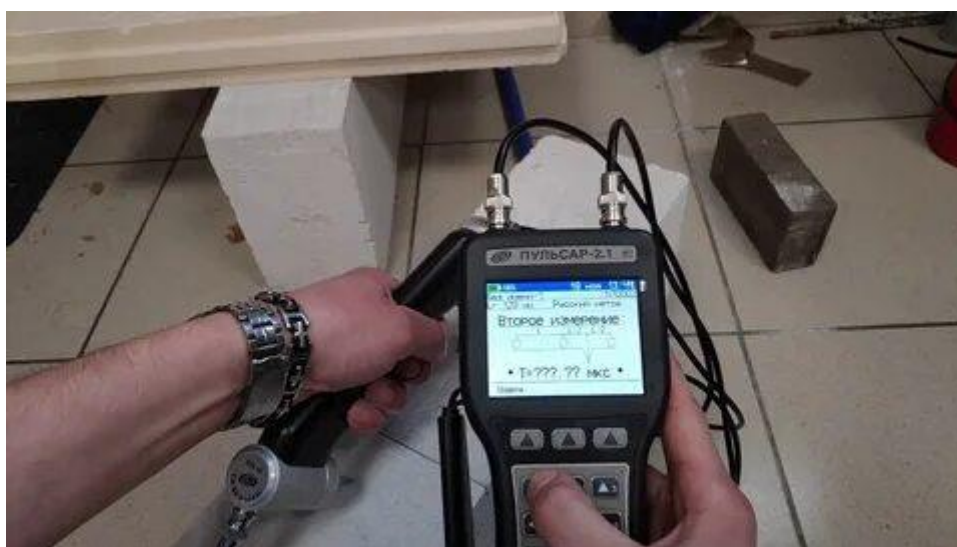
Рисунок 2.22 – Прибор для измерения скорости ультразвука «Пульсар 2.2»
