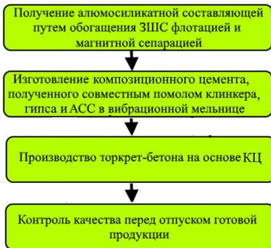
Рисунок 5.7 - Этапы производства композиционного цемента и торкрет-бетона
