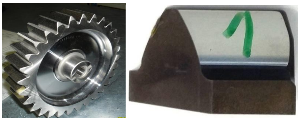
Рисунок 3.12 – Общий вид вырезки образца для исследования микроструктуры: a – общий вид зубчатого колеса; б – общий вид образца
