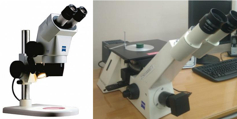
Рисунок 3.13 – Приборы для металлографического исследования: a – стереомикроскоп Zeiss Stemi 2000-C; б – оптический инвертированный микроскоп Zeiss Axivert 40 MAT
