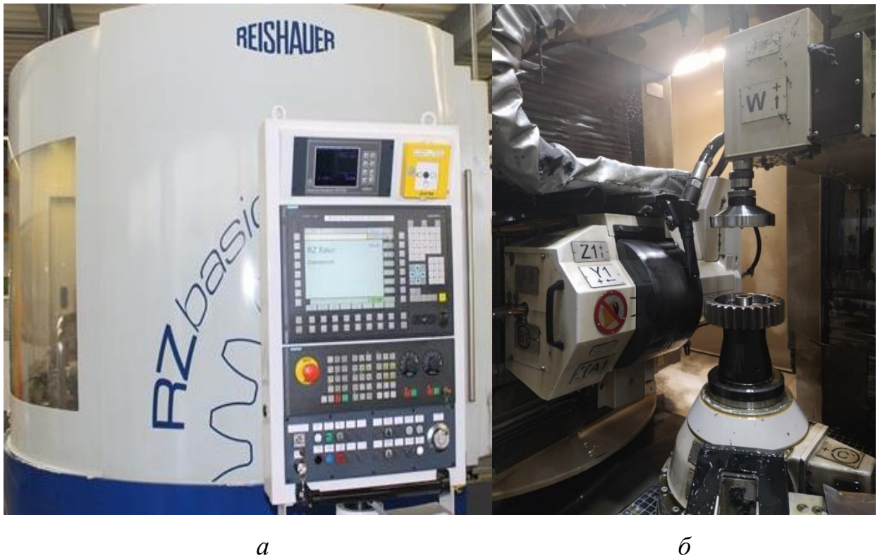
Рисунок 3.1 – Станок Reishauer RZ basic: а – общий вид; б – рабочая зона
