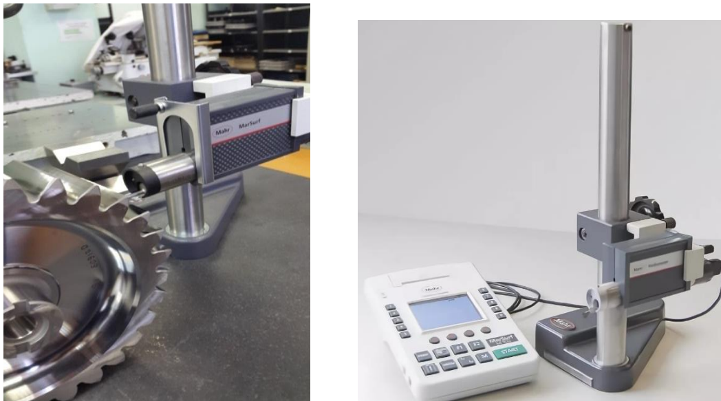
Рисунок 3.11 – Измерение шероховатости зубьев на профилометре MarSurf M300C Mahr
