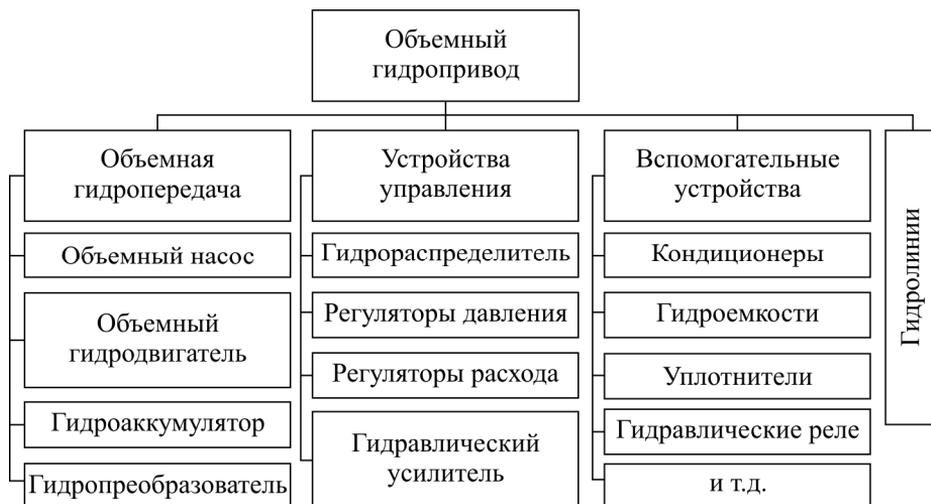
Рис. 1. Структура объемного гидропривода
