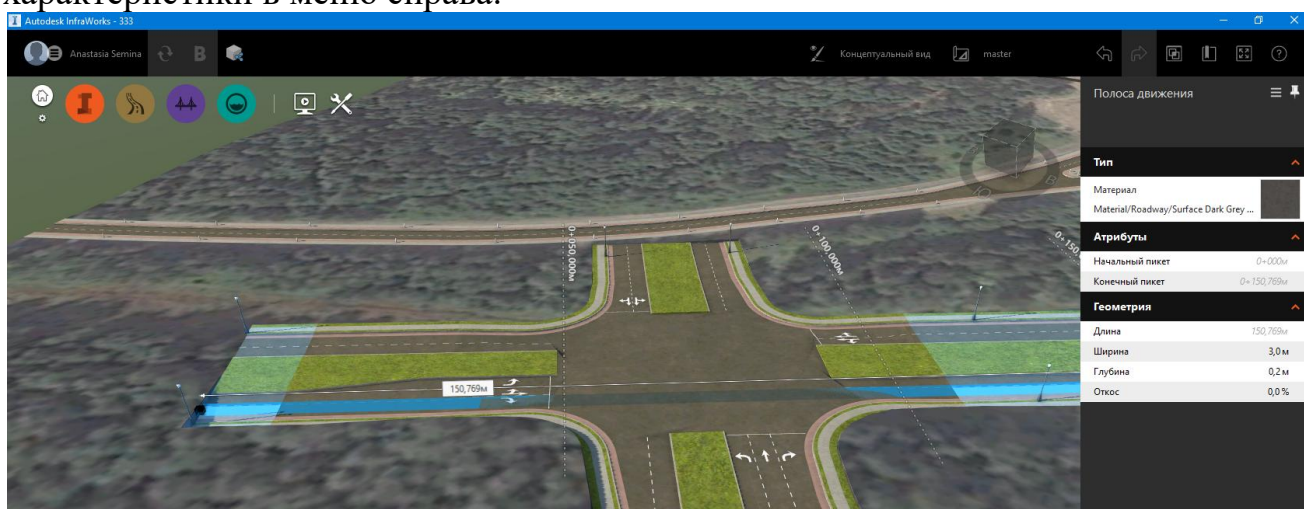
Рис. 1.6.6. Настройка характеристик полосы движения.
