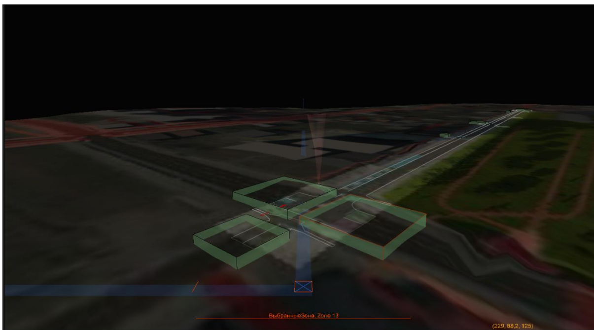
Рис. 2.3.5. Представление модели перекрестка модулем Traffic Analyst
