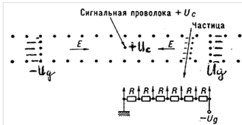
Рис. 1.21. Схема дрейфовой камеры. Точки – проволоочки в сечении. Черточки – отрицательный заряд на проволоочках
