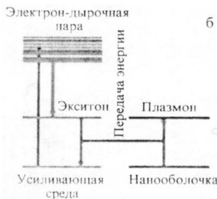
Рис.7.2. Схема передачи энергии возбуждения от активной среды в плазмонную моду нанолазера.[19]
