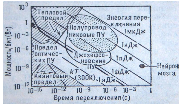
Рис.8.2. Предельные характеристики различных устройств памяти. Нейрон мозга имеет время переключения 10^{-1} с, мощность / бит (Вт) = 10^{-9} , энергию переключения 1 нДж.[1]
