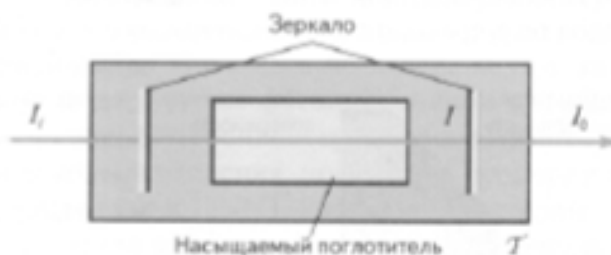
Рис.8.6. Бистабильное устройство, состоящее из насыщаемого поглотителя в резонаторе Фабри-Перро.[3]
