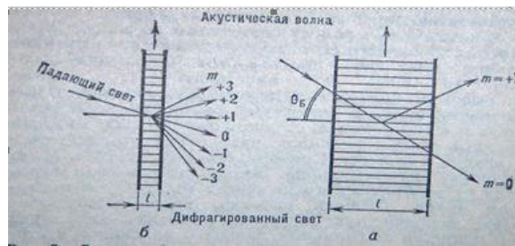
Рис.4.8. Схема дифракции света на звуковой волне. а) --при большом l (пространственная решетка). б) -- при малом l (плоская решетка).
