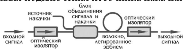
Рис.6.9. Упрощенная схема эрбиевого волоконного усилителя накачка в попутном направлении[3]
