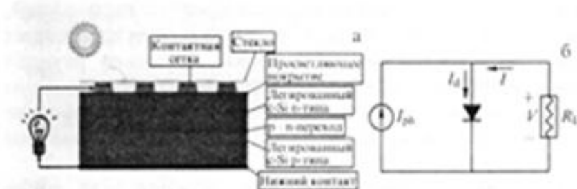
Рис.3.4. СЭ диодного типа на основе кремния. А простейший вариант с сетчатым верхним электродом. б) эквивалентная схема СЭ. Ток в нагрузке R_L состоит из темнового тока диода I_d и фототока I_{ph} [3]
