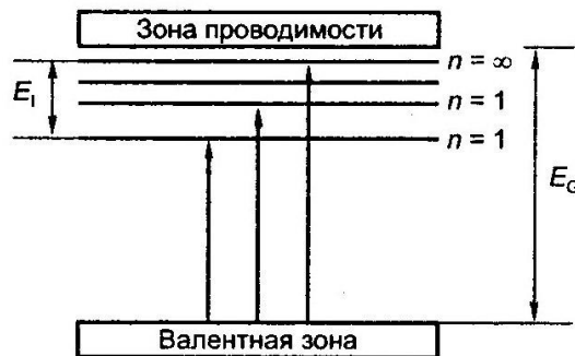
Рис. 3.9. E_1 - энергия ионизации экситона. E_G - ширина запрещенной зоны. n = 1, 2, 3, \dots квантовое число.[3]
