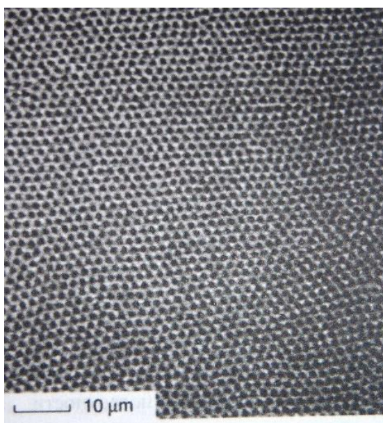
Рис. 1.63. Изображение концов цепочек магнитных наночастиц в ферромагнитной жидкости в магнитном поле перпендикулярной пленке, полученное в оптическом микроскопе. [1]
