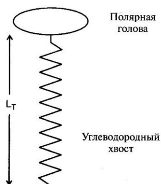
Рис. 1.78. Молекула амфифильного поверхностно-активного вещества с полярной головой и неполярным гидрофобным углеводородным хвостом. [1]
