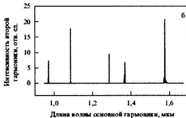
Рис. 3.35. Экспериментальный спектр второй гармоники, преобразованной на квазиПДС в танталате лития. [7]. Длина волны второй гармоники равна половине длине волны основной гармоники. Слева направо (в мкм): 0,48 – голубая, 0,54 - зеленая, 0,64, 0,68 – красные, 0,785 – инфракрасная.
