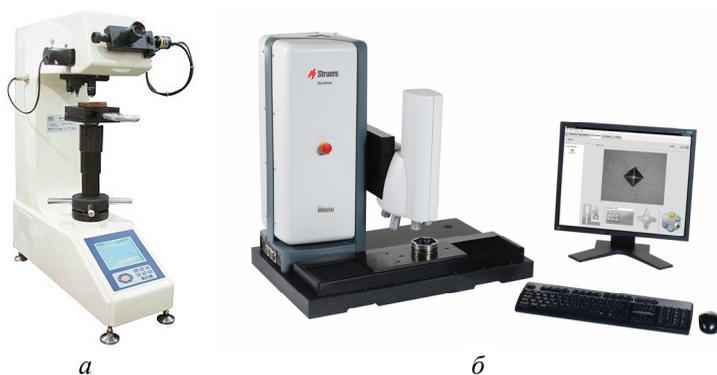
Рис. 6.2. Твердомеры: *а* – твердомер Виккерса HV-30; *б* – микротвердомер Дюраскан 70
