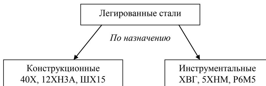
**Легированные конструкционные стали общего (ГОСТ 4543-74) и специального (ГОСТ 5632-78) назначения** маркируются сочетанием букв и цифр. В начале марки **первые две или три цифры** показывают среднее содержание углерода в сотых долях процента. Расшифровка обозначений легирующих элементов приведена в табл. 2.
