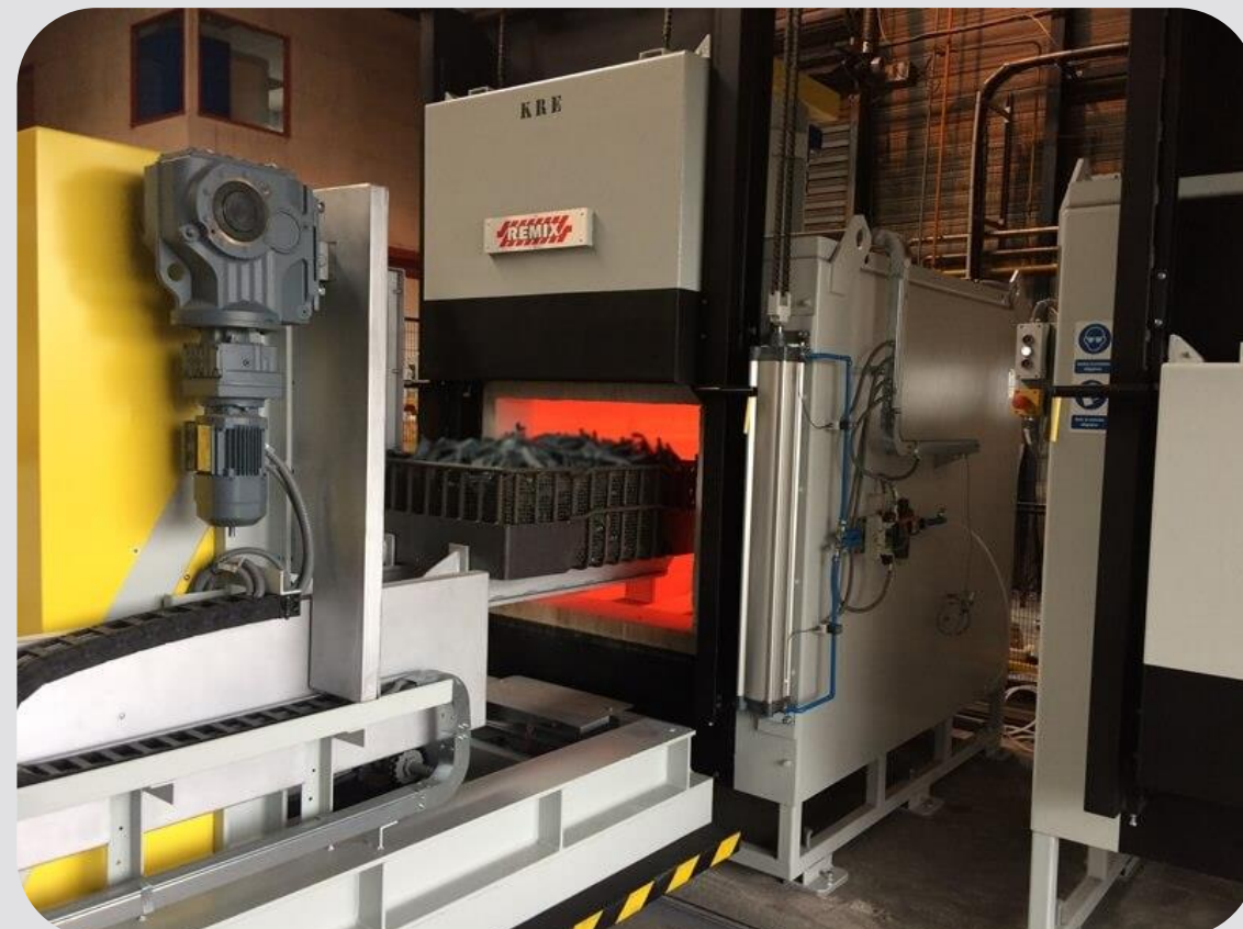
Печь камерного типа, в которой возможна ТО деталей небольших размеров
