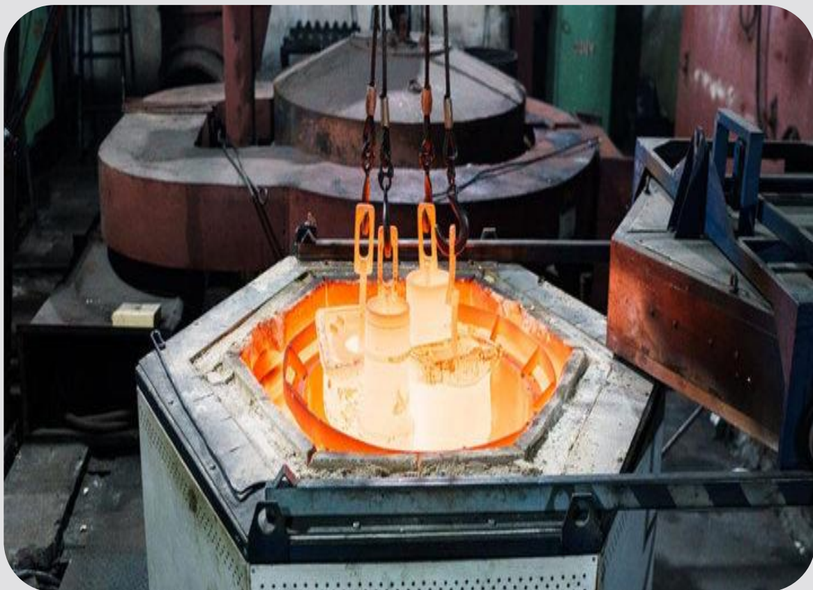
Печь шахтного типа, в которой возможна ТО деталей большой длины (осевой вал)
