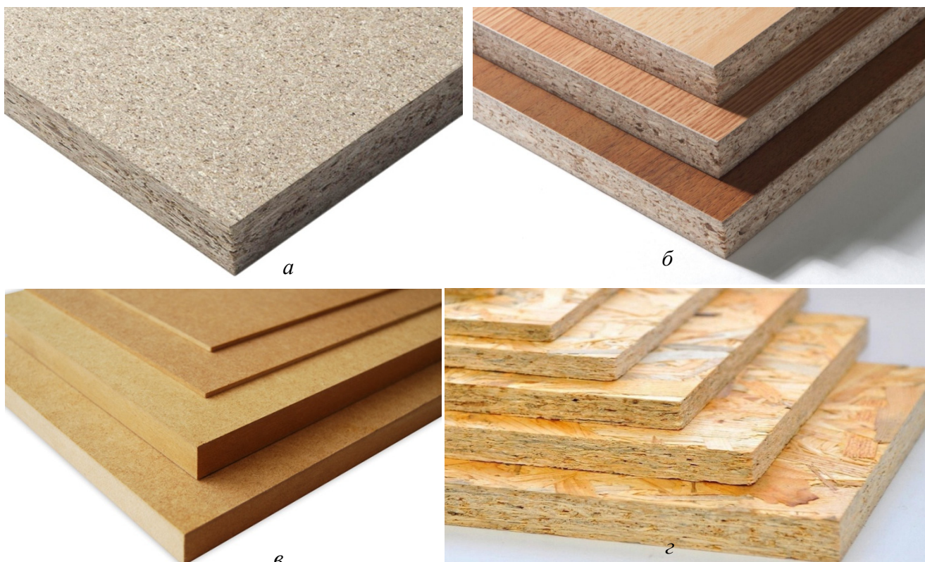
Рис. 1.7. Разновидности древесностружечных плит: а – из стружки средней фракции (ДВП); б – ламинированные ДВП; в – из стружки мелкой фракции (МДФ); г – из крупной стружки, щепы (OSB)
