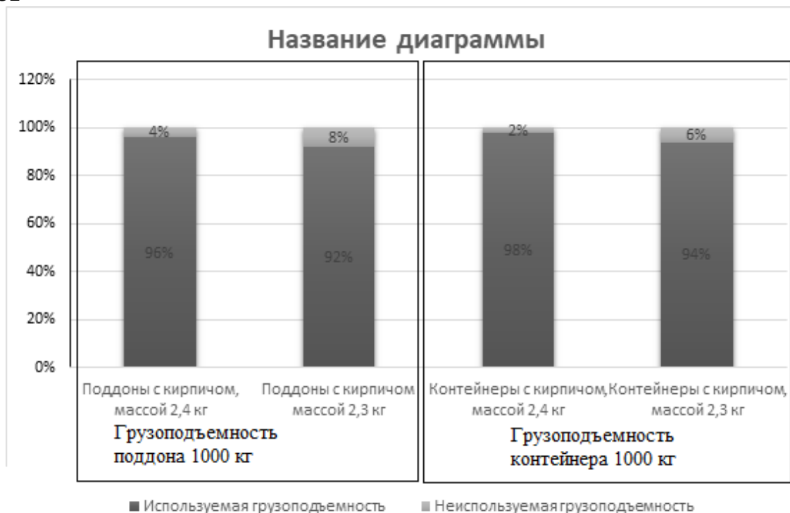
Рис. 33 - Вариант №2. Процентное соотношение использования грузоподъемности поддонов и контейнеров
