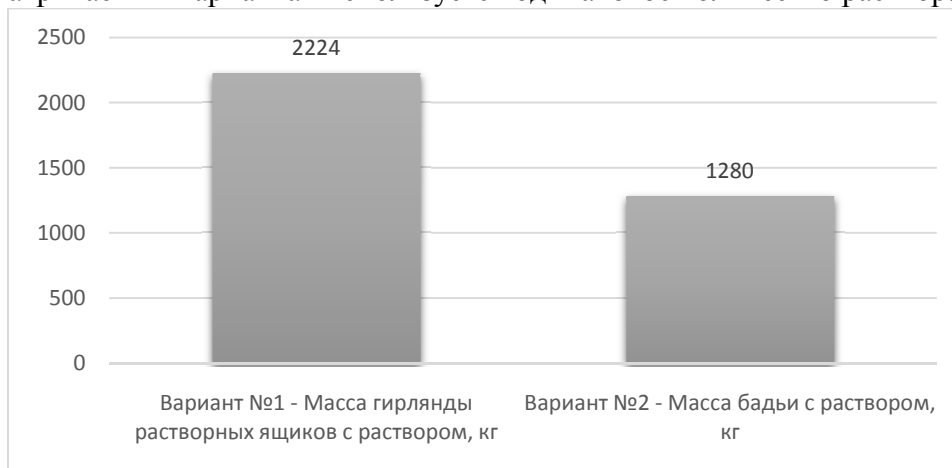
Рис. 37 - Сопоставление массы поднимаемых средств для подачи раствора
