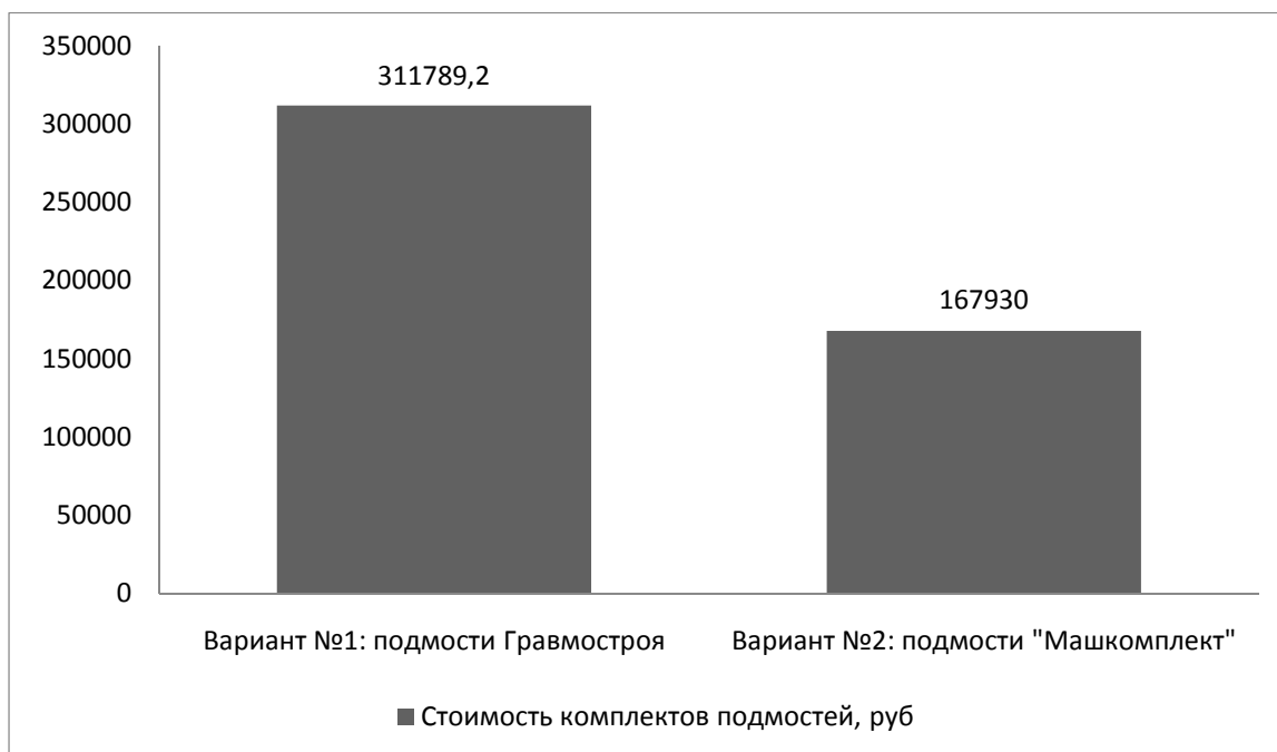
Рис. 25 – Сравнение стоимости комплектов подмостей
