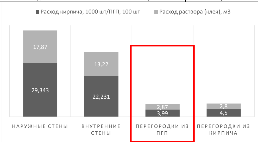
Рис. 8 - Вариант №1. Общий расход материалов по типовому этажу
