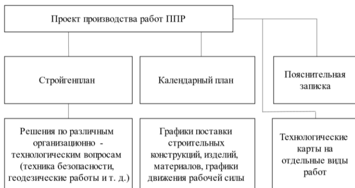
Рис. 4.2. Состав проекта производства работ
