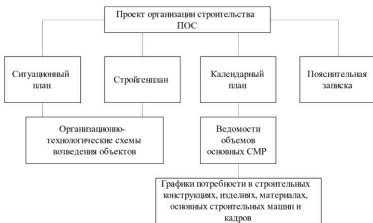
Рис. 4.1. Состав проекта организации строительства
