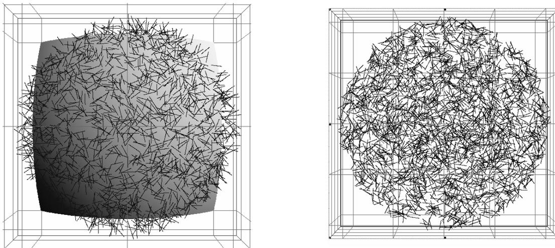
Рис.3. Распределение армирующих волокон на поверхности параболоида вращения
