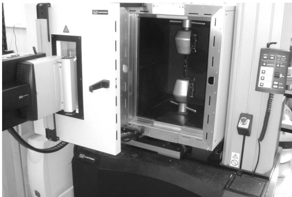
Рис. 2.2. Климатическая камера с видеоэкстензометром AVE в составе испытательной системы
