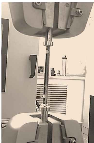
Рис. 3.10. Образец базальтопластика в захватах испытательной системы Instron5882 во время испытания на растяжение
