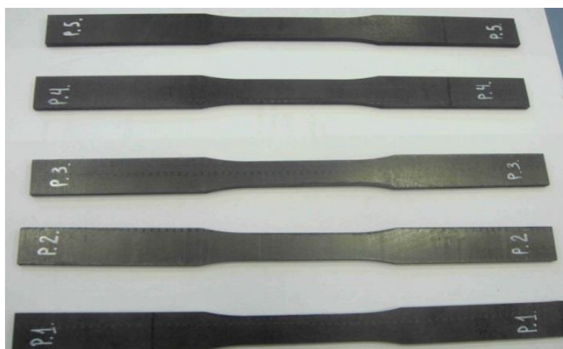
Рис. 3.2. Образцы углепластика в виде лопаток для испытаний на одноосное растяжение.
