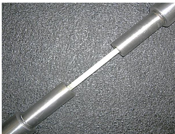
Рис. 3.8. Образец однонаправленного стеклопластика, вклеенный в специальные захватные гильзы, для испытаний при пониженных температурах
