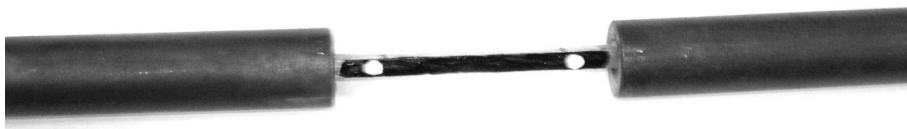
Рис. 3.6. Внешний вид образца высоконаполненного стеклопластика для проведения испытаний на одноосное растяжение с нанесенными метками для возможности использования бесконтактного экстензометра Instron AVE
