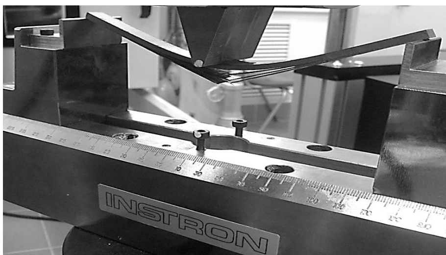
Рис. 3.15. Разрушенный в ходе испытания на трехточечный изгиб образец углепластика
