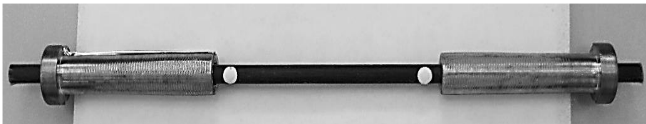
Рис. 2.4. Закрепление образцов однонаправленных композитов в разъемные втулки
