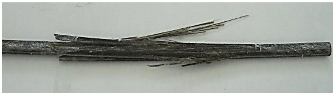
Рисунок 3.12. Вид разрушенного образца базальтопластика после испытания на растяжение
