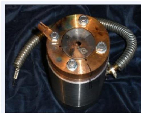
Рисунок 1.9. Устройство для измерения профиля пучка. Входной диск имеет 7 щелей
