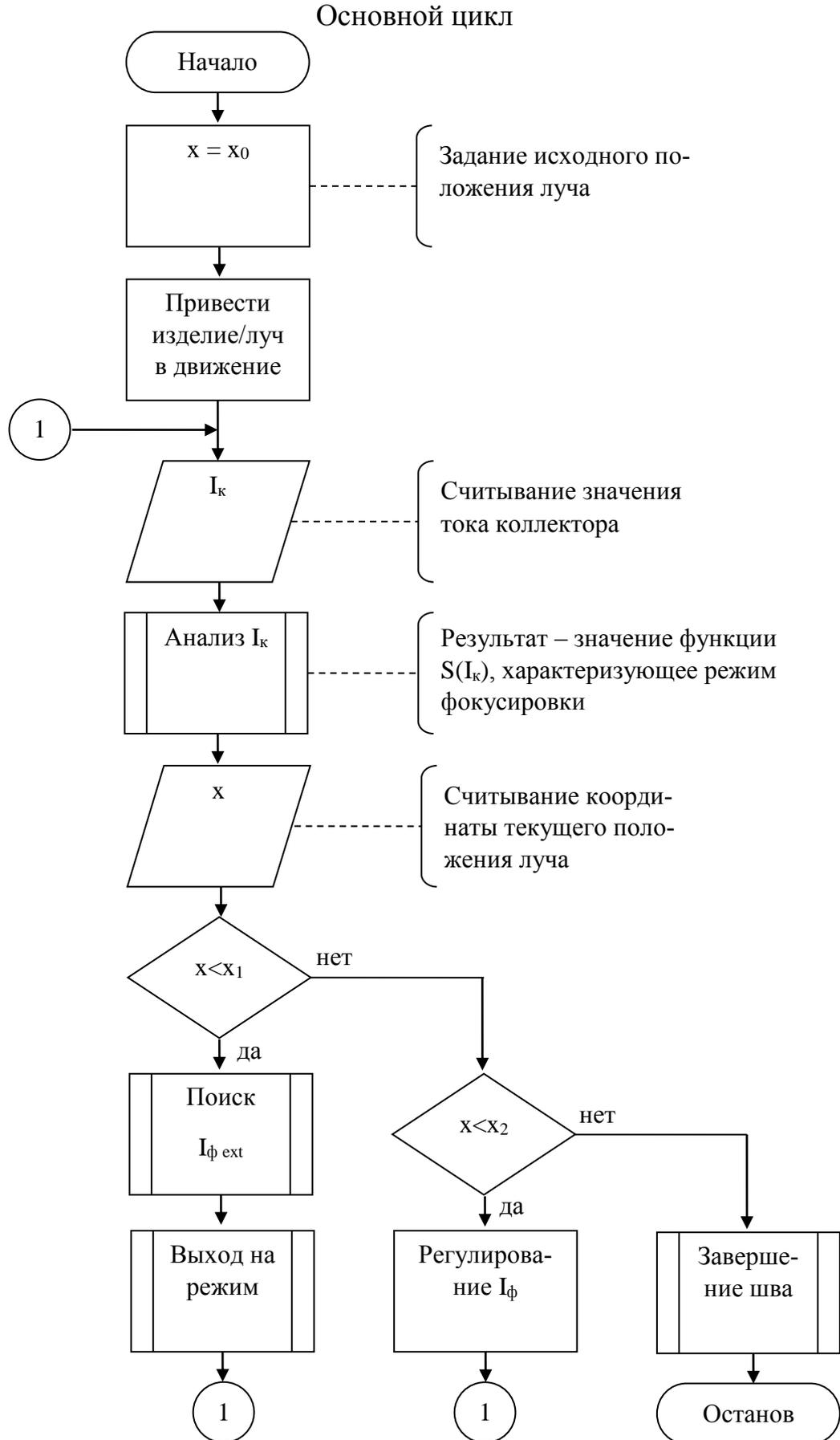
Рисунок 4.2 – блок-схема алгоритма работы системы управле-
