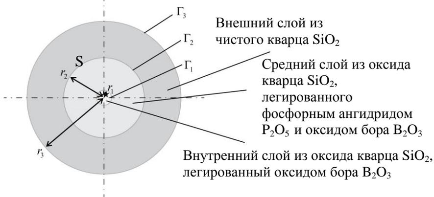
Рис.1. Схема осевого сечения заготовки силового стержня:
