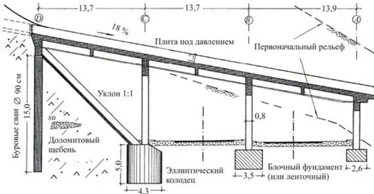
Рис. 3.8. Противообвальная галерея на крутом склоне
