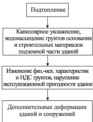
Рис. 1.4. Последствия подтопления
