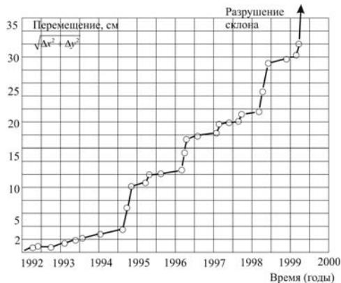
Рис. 3.23. Неравномерная ползучесть неустойчивого склона с низким остаточным сопротивлением сдвигу. Возрастание риска внезапного обрушения с ростом деформаций
