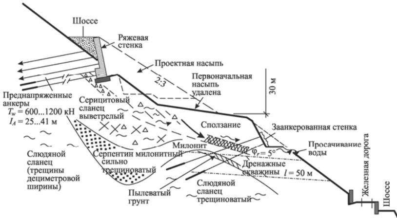
Рис. 3.25. Конструкция шоссе на геологическом сбросе: стабилизация сползающего склона путем быстрого удаления первоначально отсыпанной запроектированной насыпи; новый проект состоит из заанкероанных ряжевых подпорных стен, заанкероанных элементных стенок и дренажных скважин
