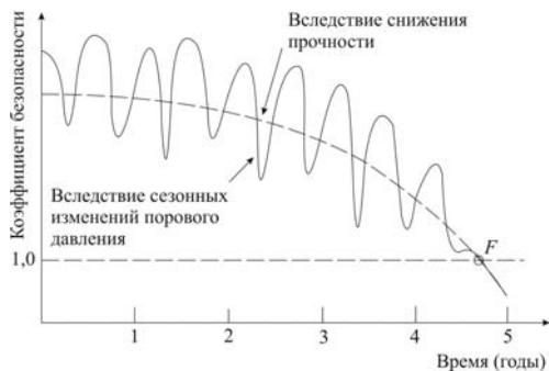
Рис. 3.24. Эволюция коэффициента безопасности склона во времени при снижении прочности материала
