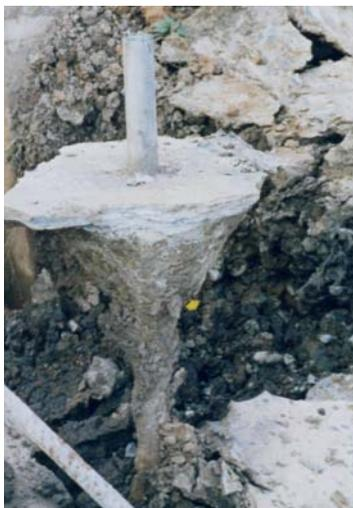
Рис. 3.60. Отсутствие зоны закрепленного грунта вокруг иньектора
