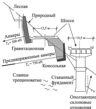
Рис. 3.39. Полумост на неустойчивом глубоком склоне с целью минимизации подрезки склона и отсыпки насыпи
