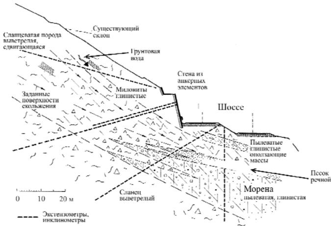
Рис. 3.29. Стабилизация верхней зоны неустойчивого склона высотой 800 м, который необходимо подрезать до высоты 45 м для строительства многополосной скоростной автомагистрали. Две анкерные стенки длиной 250 м с 800 преднапряженных анкеров (не изображены)
