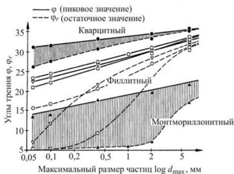
Рис. 3.21. Экспериментальные зависимости угла трения милонитов от размера частиц
