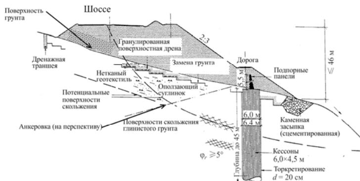
Рис. 3.33. Разрез по кессонной стене, на котором представлены железобетонные панели по верху кессонов на случай чрезвычайных обстоятельств для возможности дальнейшей установки преднапряженных анкеров
