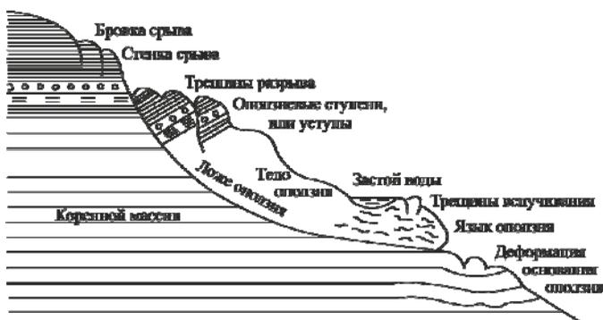
Рис. 1.1. Продольный разрез склона с телом оползня
