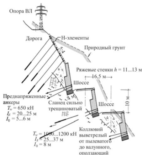
Рис. 3.28. Несколько шоссе на крутом неустойчивом склоне: стабилизация с помощью мультизаанкерованных ряжевых и заанкерованных железобетонных стен
