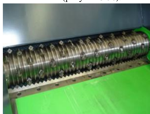
Рисунок 3.36 – Конструктивные исполнения роторов одновальных шредеров
