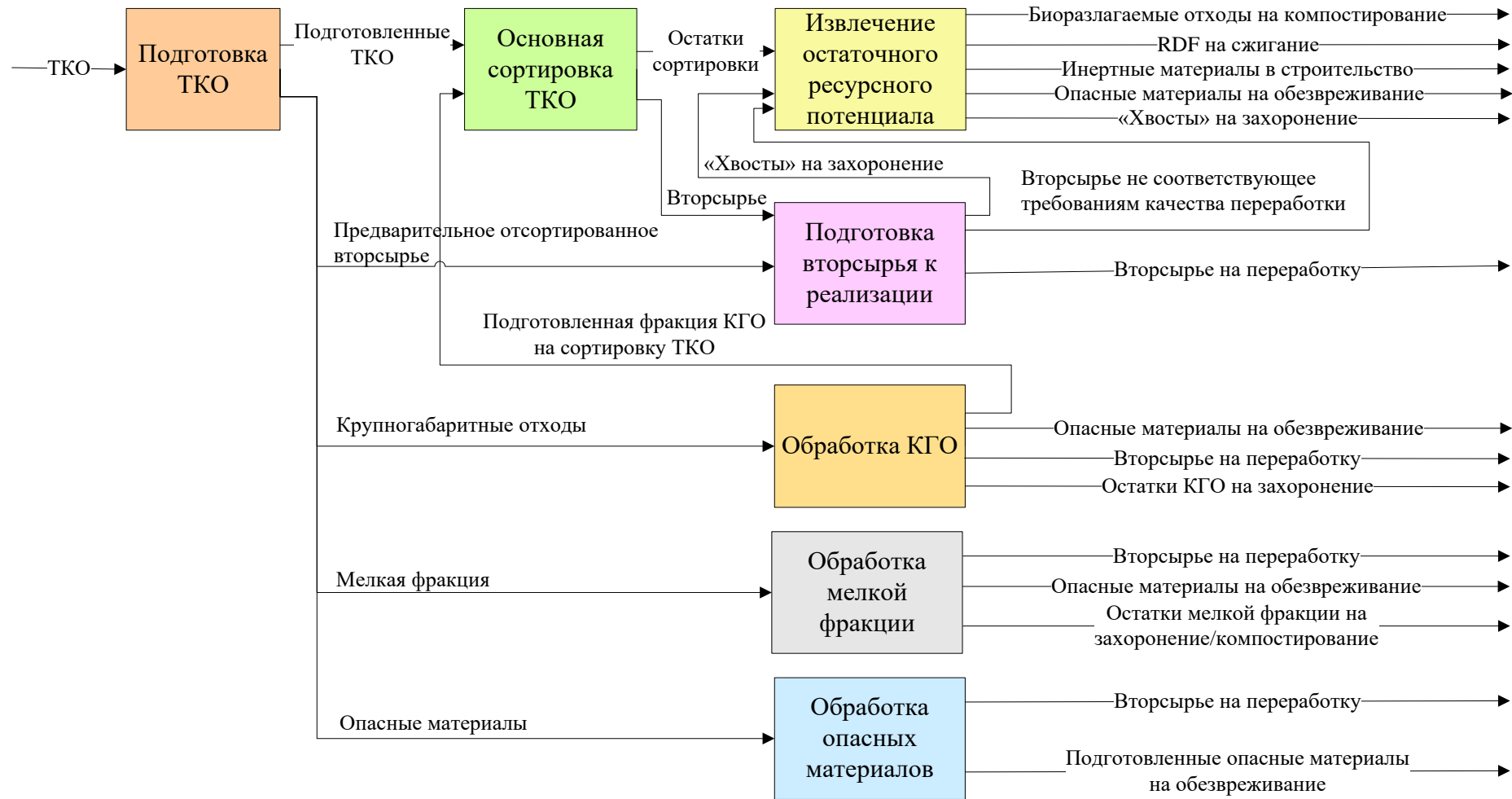
Рисунок 2.1 – Технологическая схема сортировки TKO
