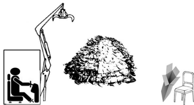
Рисунок 3.8 – Отделение крупногабаритных отходов напольным стационарным манипулятором
