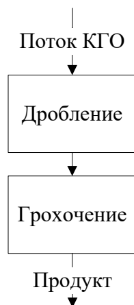
Рис. 3.29 – Схемы встраивания подэтапа дробления только КГО в технологическую схему сортировки
