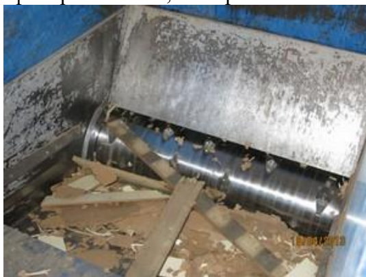
Рисунок 3.36 – Конструктивные исполнения роторов одновальных шредеров
