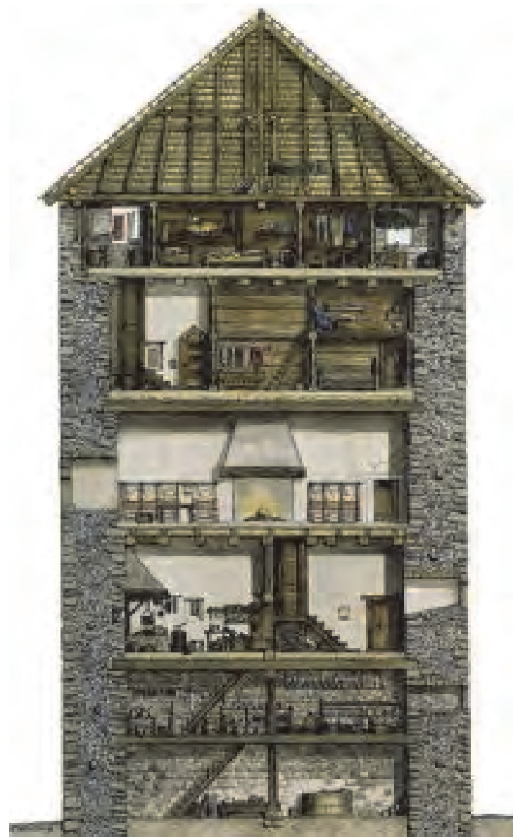
Типичный разрез жилой башни XII века. Здесь – замок Абенберг , Германия
