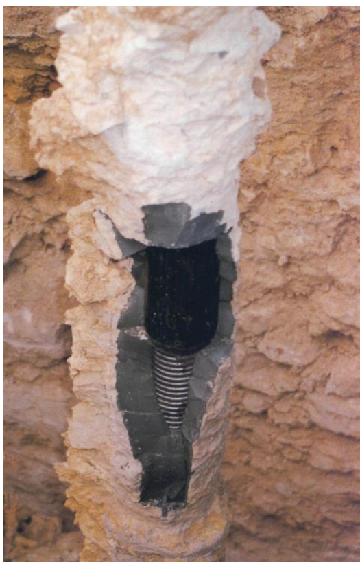
Рис. 4.47. Инъекционный анкер в грунте
