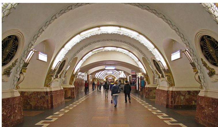
Рис. 3.48. Трехсводчатая станция «Площадь Восстания» в г. Санкт-Петербурге
