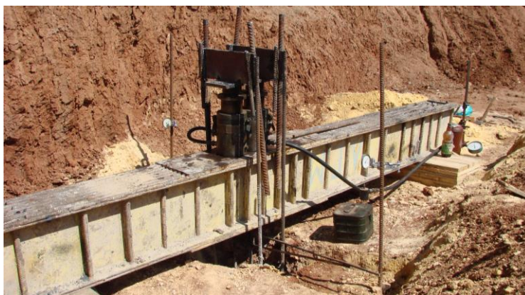
Рис. 7.8. Нагружение сваи выдерживающими нагрузками
