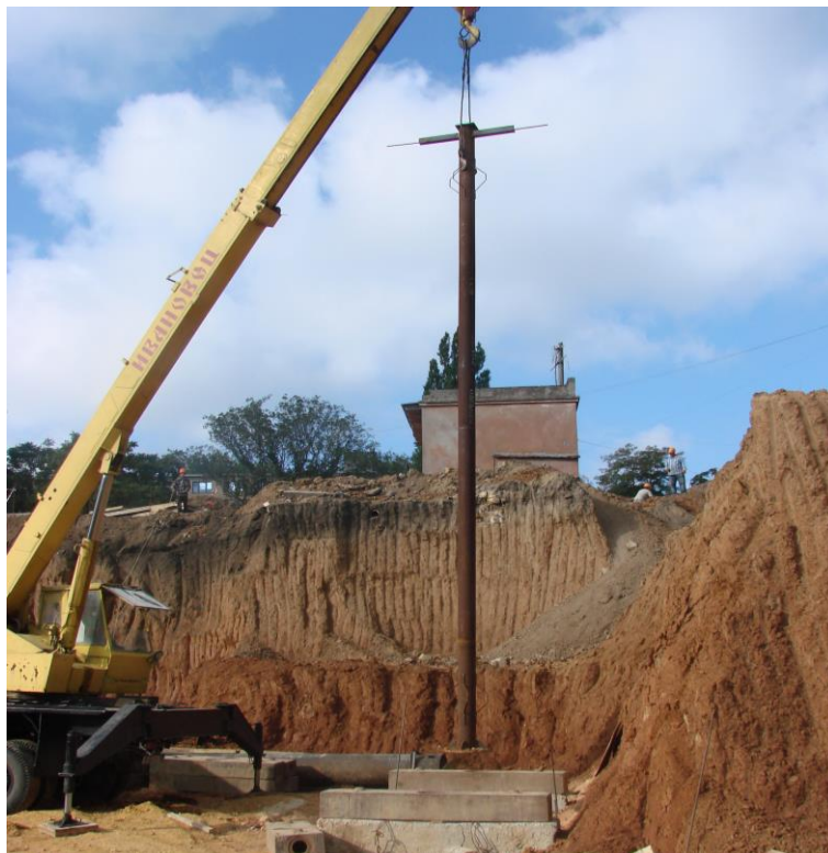
Рис. 7.9. Общий вид штампа для испытаний ракушечника на продавливание
