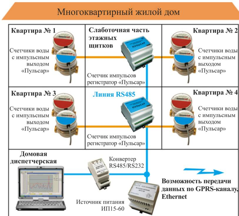
Рис. 13. Пример организации системы контроля водопотребления многоквартирного дома (фото с сайта <http://yet.pp.ua>)
