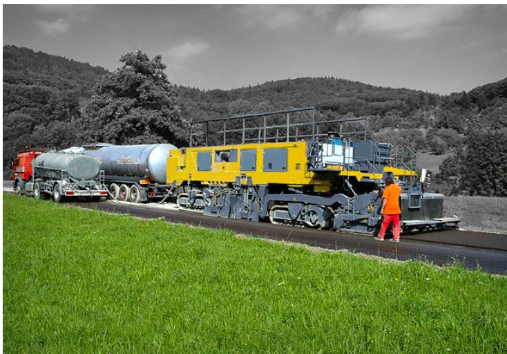
Рис. 34. Комплекс для фрезерования, переработки и укладки готовой асфальтобетонной смеси (фото с сайта <http://www.unidorstroy.kiev.ua>)
