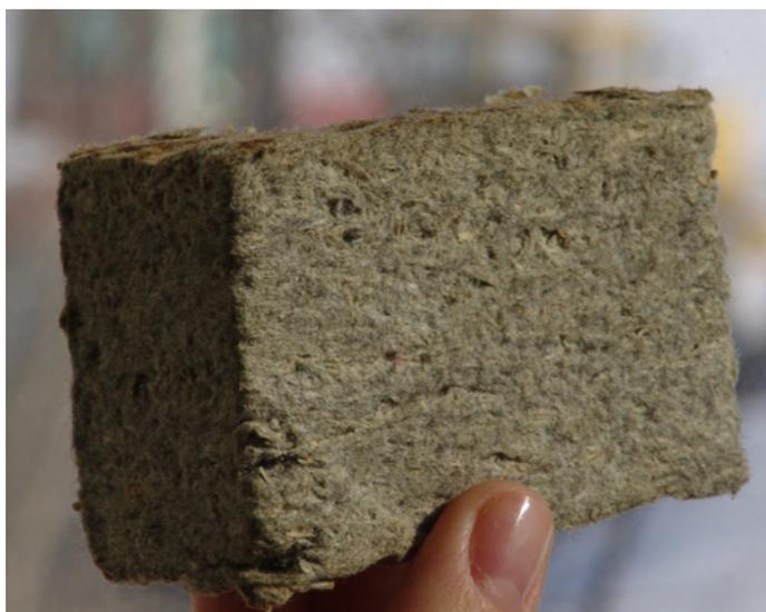
Рис. 33. Теплоизоляционная плита, выполненная с применением макулатуры (фото с сайта <http://www.nipier.ru>)
