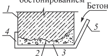
Восстановление поврежденной поверхности обетонированием
