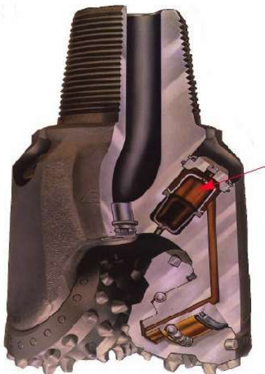
Рис. 3.6. Схема долота с герметизированной маслonaполненной опорой
