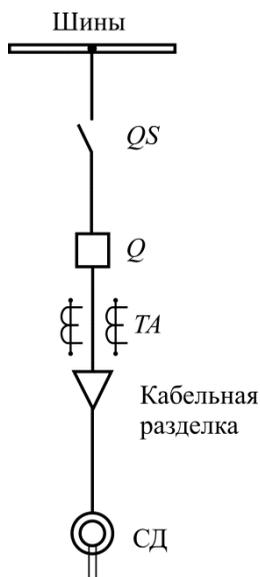
Рис. 7. Однолинейная электрическая схема ячейки управления работой высоковольтного синхронного электродвигателя
