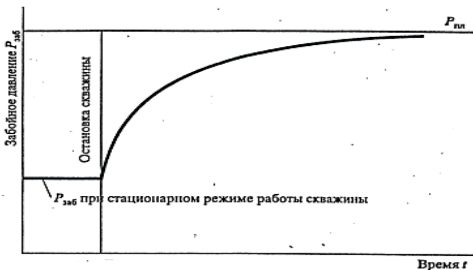
Рис.9.2. Кривая восстановления забойного давления
