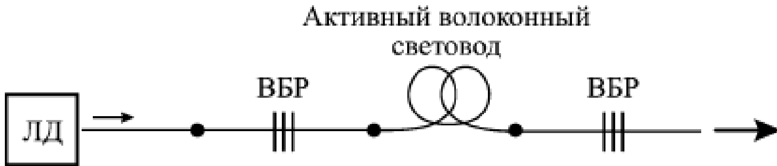
Схема непрерывного волоконного лазера
