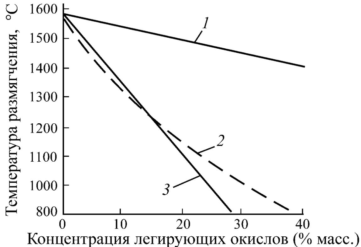
**Зависимости температуры размягчения легированного кварцевого стекла в зависимости от его состава и концентрации легирующих компонентов:**
