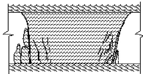
Характер перераспределения вертикальной нагрузки на целики в процессе ведения горных работ
