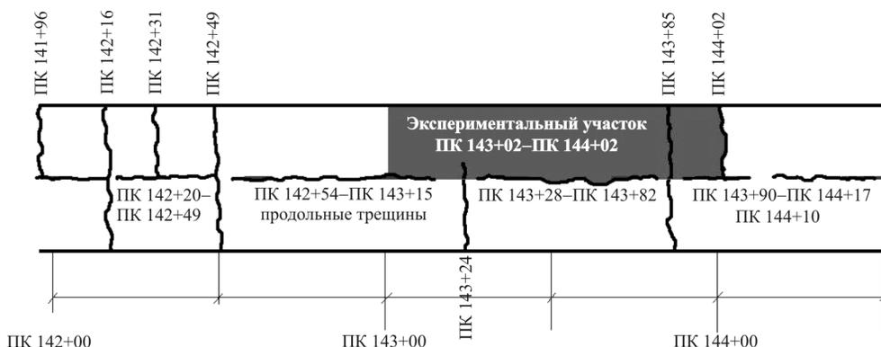
Рис. 3. Схема распространения поперечных и продольных трещин на участке автомобильной дороги Чита – Хабаровск на 365-м километре (ПК 142+00 – ПК 144+02), установленных в 2009 г.
