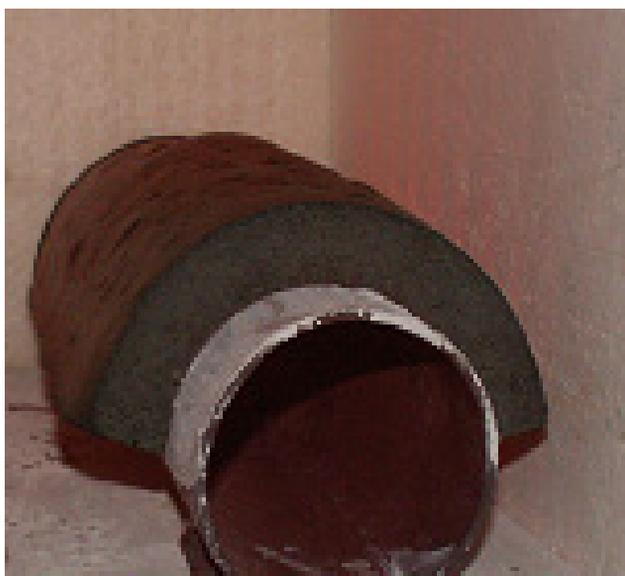
Рис. 2. Пеностеклянное изделие по предлагаемой технологии
