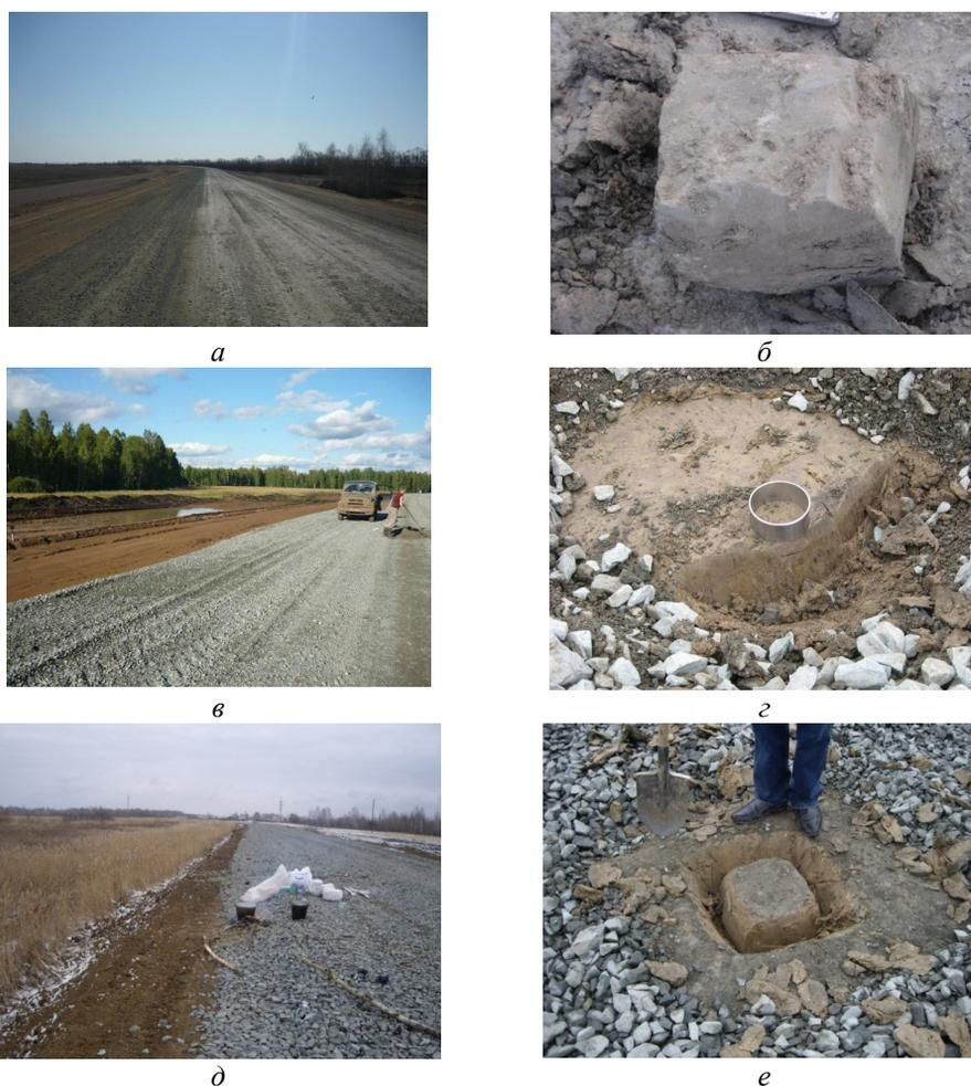
Рис. 1. Экспериментальные участки земляного полотна: *а, б* – общий вид и отбор пробы стабилизированного грунта с а/д Карасук – Калиновка (южная часть НСО); *в, з* – общий вид и отбор пробы стабилизированного грунта с а/д Межовка – Северное (западная часть НСО); *д, е* – общий вид и отбор пробы стабилизированного грунта с а/д в с. Убинское (центральная часть НСО)
