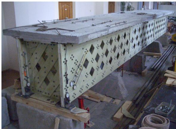
Рис. 1. Опытное пролетное строение
